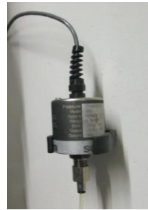
Fotografía 2-22 Transductor de presión aguas arriba
