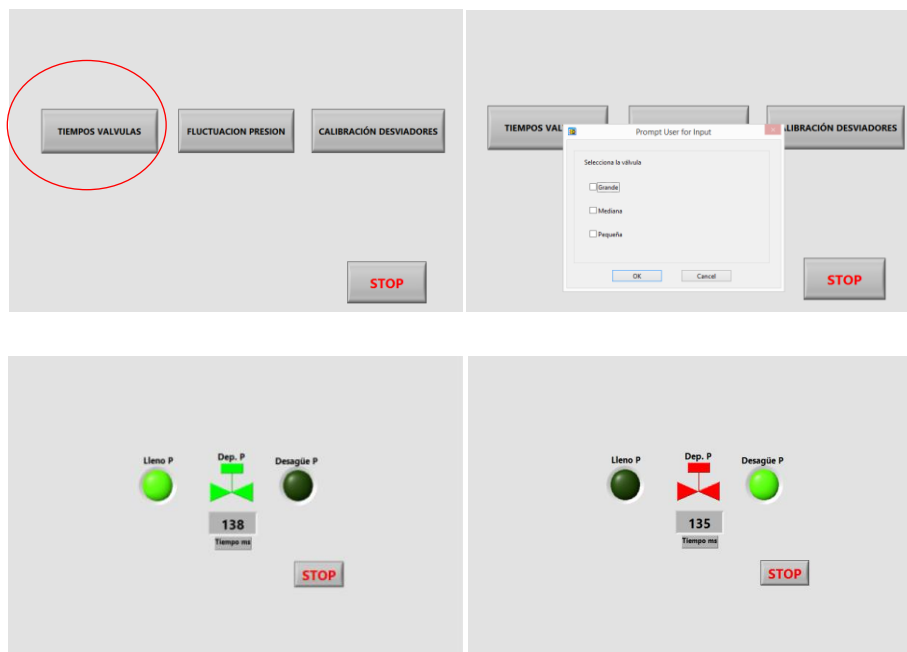
Ilustración 2.10 Pantallas programa lectura tiempos apertura/cierre válvulas desviadoras de flujo
