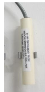
Fotografía 2-3 Sensor de temperatura y humedad ambiente
