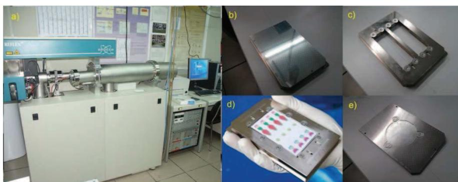
Fig 3.3.1. Material de Bruker a) Espectrómetro de masas Reflex IV, b) Placa de 384 pocillos, c) Placa soporte para portamuestras, d) Placa soporte para TLC, e) Placa soporte para Obleas nanoestructuradas.
