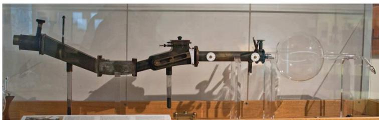
Fig 1.1.1 Réplica del primer espectrómetro de masas de J.J. Thomson.
