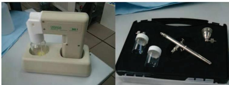
Fig 3.1.1. Espray DESAGA (izda) y aerógrafo HANSA (dcha).
