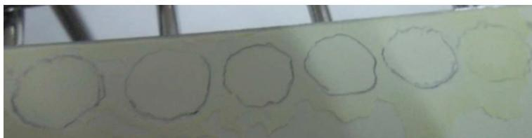
Fig 5.1.1. Distribución en la placa de las muestras. De izquierda a derecha: LPC, PC, PE, SM, PS y PEG.
