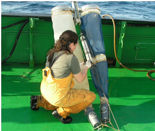
Figura 3.5: Preparación del lance de la red Calvet doble para toma de muestras de zooplancton.
