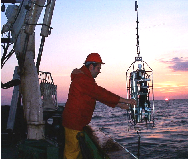
Figura 3.3: Lance de CTD para toma de datos hidrográficos.
