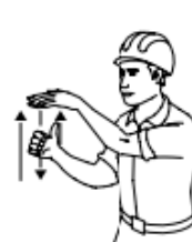
4 LEVANTAR EL AGUILÓN O PLUMA LENTAMENTE
