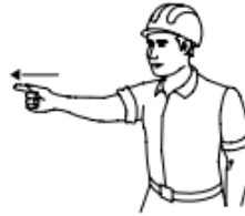
11 GIRAR EL AGUILÓN EN LA DIRECCION INDICADA POR EL DEDO
