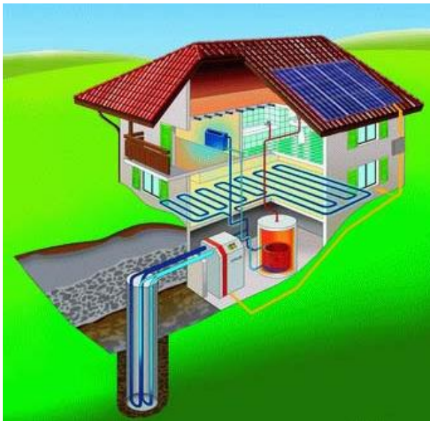
Imagen 4 Descripción de sistema de calefacción mediante geotermia y detalle de bomba de calor
