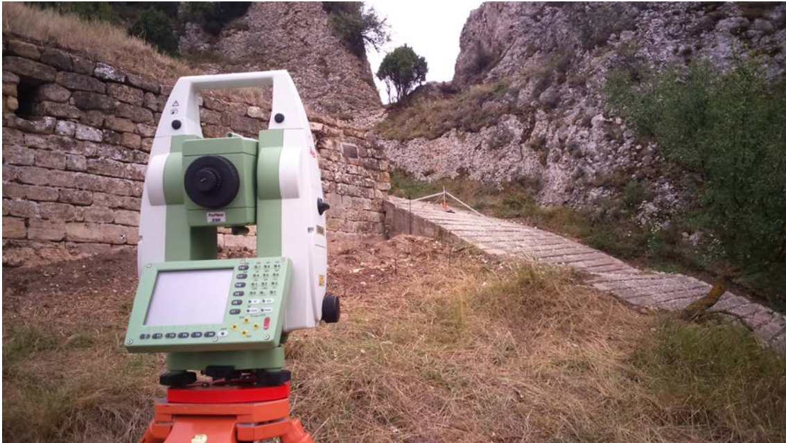
Fig. 5.- Estación total utilizada para la medida de la red de referencia: clavos y dianas.
