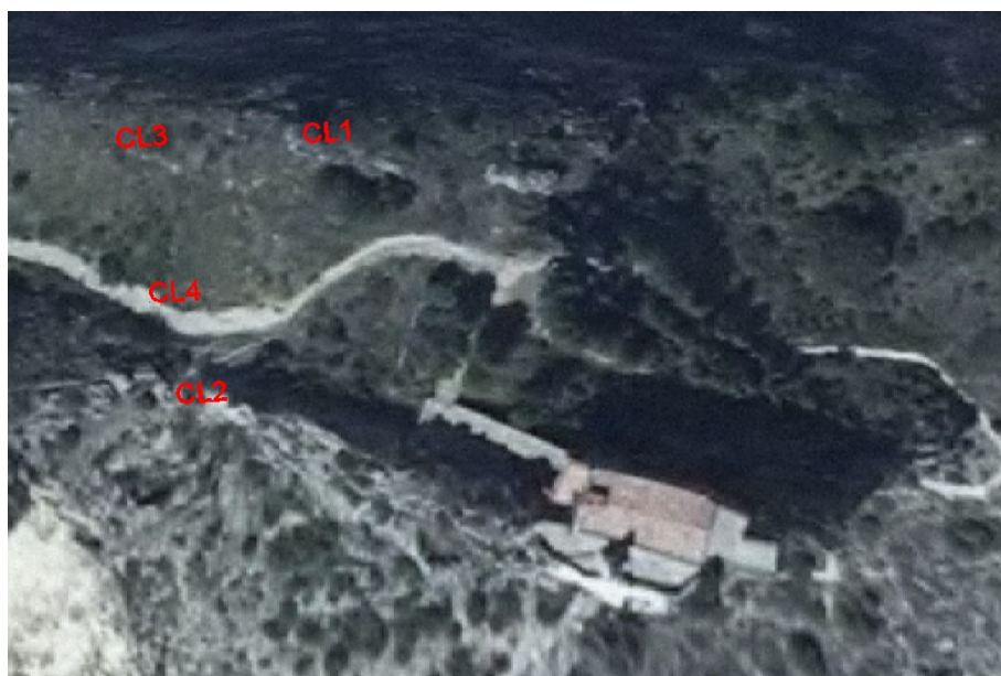
Fig. 8.- Localización de los cuatro clavos correspondientes a la red topográfica establecida para este proyecto.
