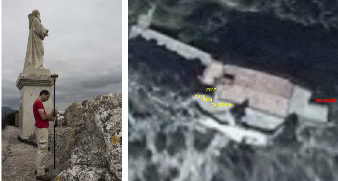
Fig. 10.- Observación GNSS de una diana junto a la estatua de San Felices (izquierda) y croquis de situación de las dianas y del clavo localizado en las terrazas situadas sobre el tejado de la ermita (en rojo a la derecha).
