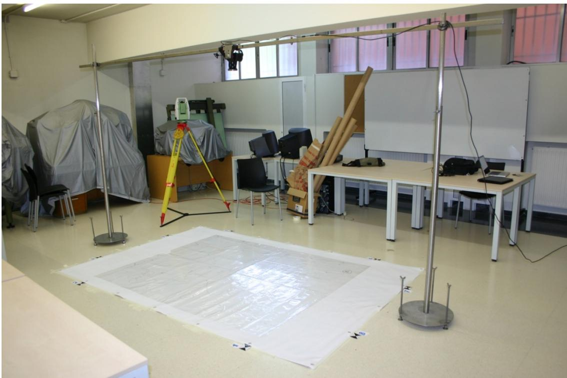
Fig. 12.- Vista de la lona con el plástico desplegado, las dianas situadas alrededor tienen coordenadas que se han medido con la estación total que se muestra en la imagen. La cámara se encuentra suspendida a unos 2 metros de altura.
