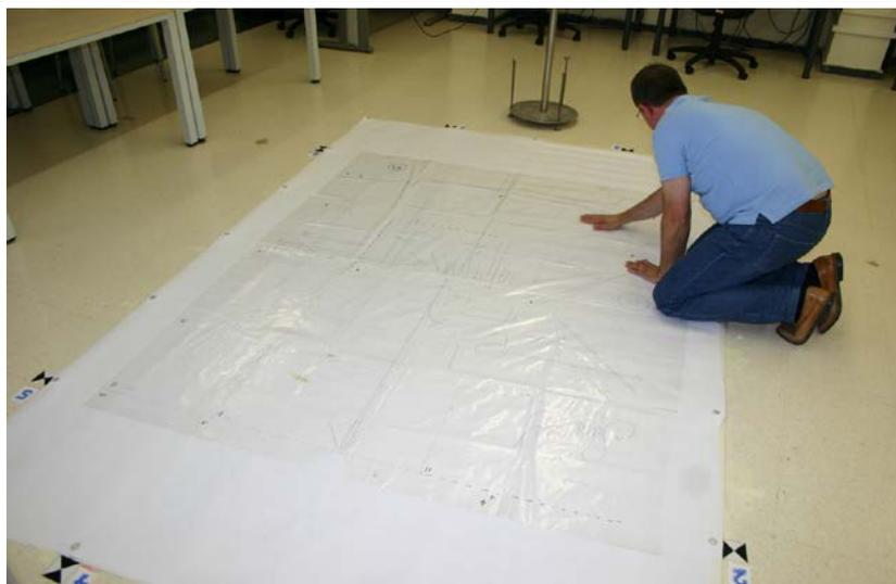
Fig. 14.- Colocación y alisado de un plástico pequeño (1,5 metros de ancho).
