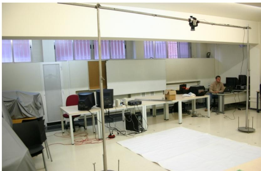
Fig. 5.- Estructura para la toma de fotografías: la cámara se mantiene suspendida en la vertical y es controlada remotamente desde el ordenador. Por otro lado, los plásticos se despliegan sobre la lona situada en el suelo.
