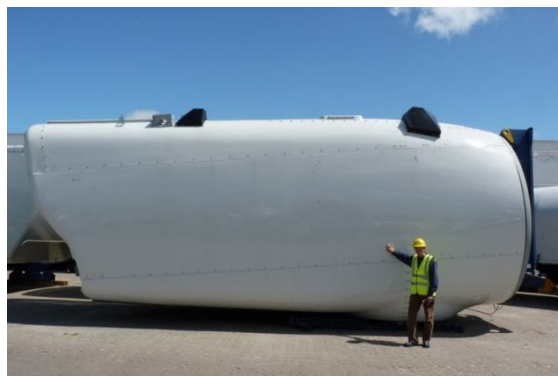
Figura 30. Góndola de aerogenerador.
