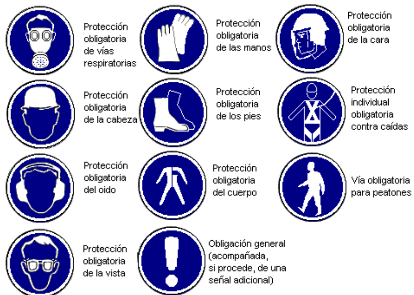
Figura 3. Señalización de obligación
