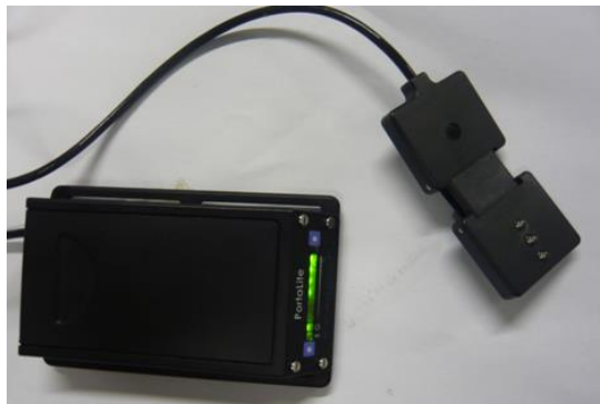
Irudia 3: Neurketan erabilitako NIRS sistema.
