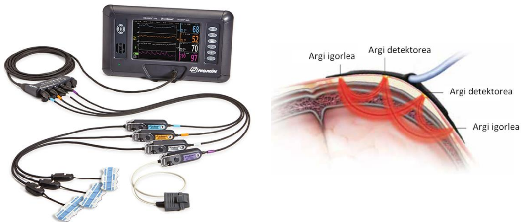
Irudia 8: NONIN SenSmart sistema (ezkerra). EQUANOX sentsorearen funtzionamendua (eskuina).
