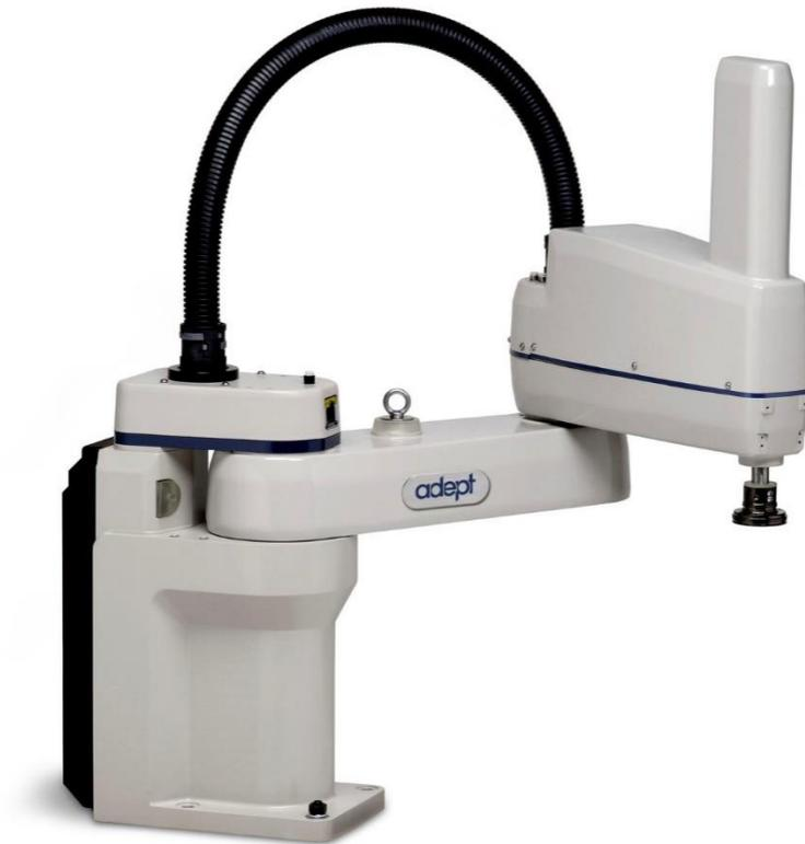
Abbildung 54. Kleiner SCARA Roboter (Adept, 2016)
