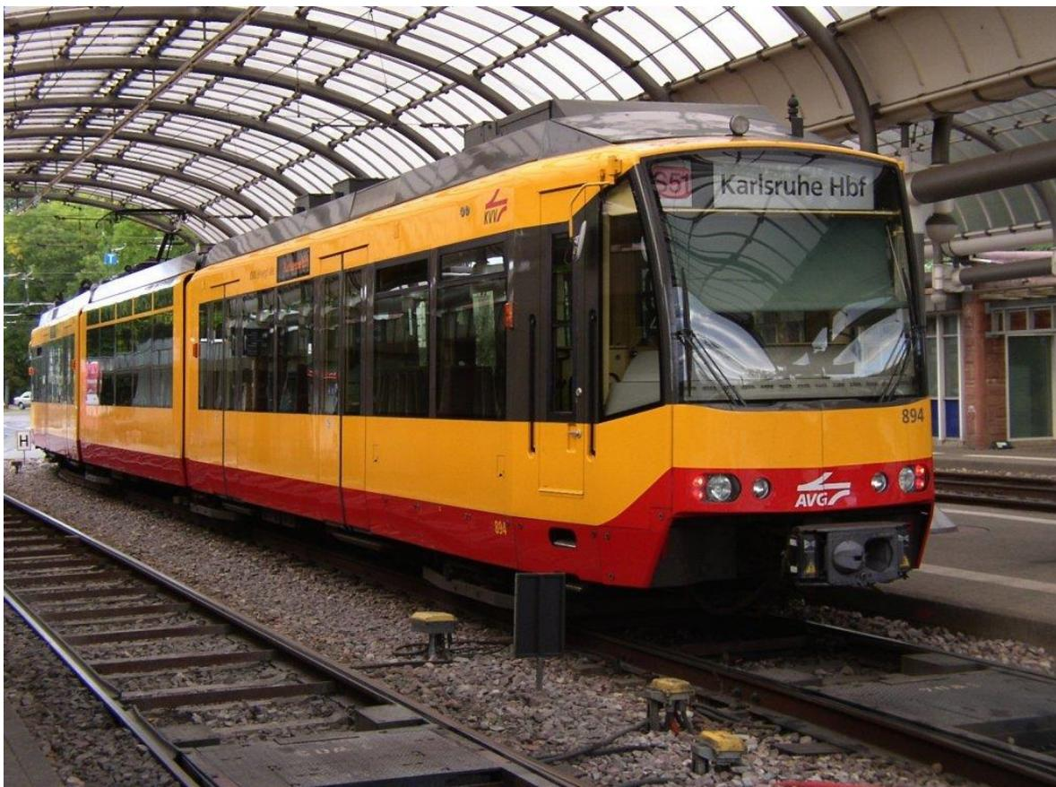
Abbildung 30. Karlsruher S-Bahn mit Scharfenbergkupplung (Magnus, 2012)
