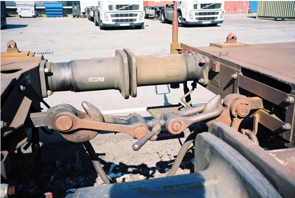
Abbildung 1. Schraubekupplung (Wikipedia, Schraubekupplung, 2015)
