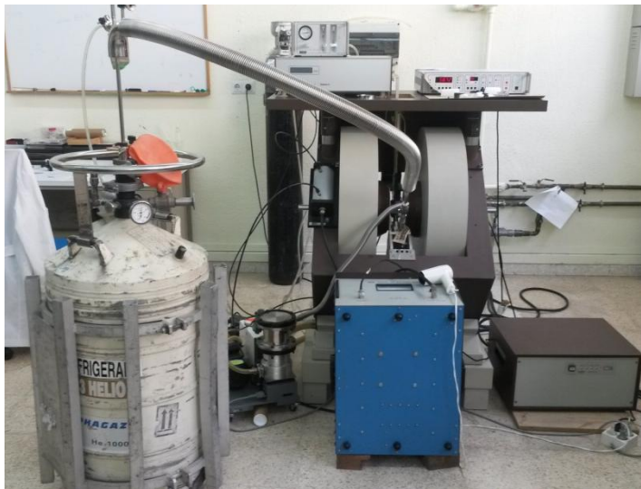
Figura 3.1: Instrumento ELEXSYS empleado para la medida FMR de la película delgada
