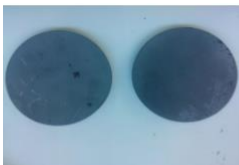
Figura 12. Planchas de hierro para aumentar la capacidad de generación de campo magnético.
