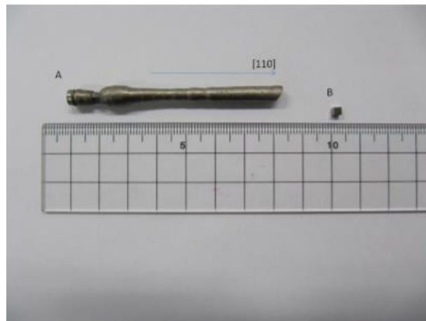
Figura 16. Monocristal fabricado y muestras cortadas entre las que se encuentra una de las utilizadas en nuestro trabajo (muestra B)
