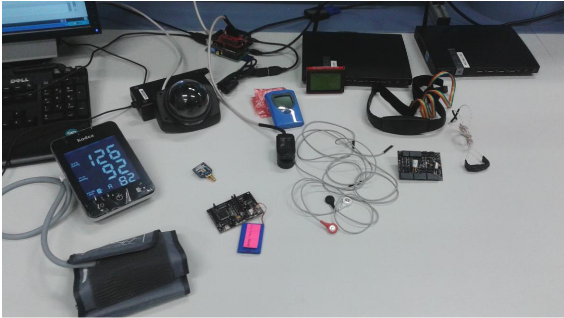
Figura 5-1: Infraestructura del demostrador: e-Health Sensor Platform, kit de sensores de gas y unidades de procesamiento
