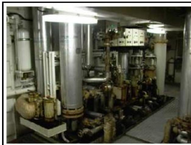
Figura 79. Módulo de combustible del buque Sorolla.
