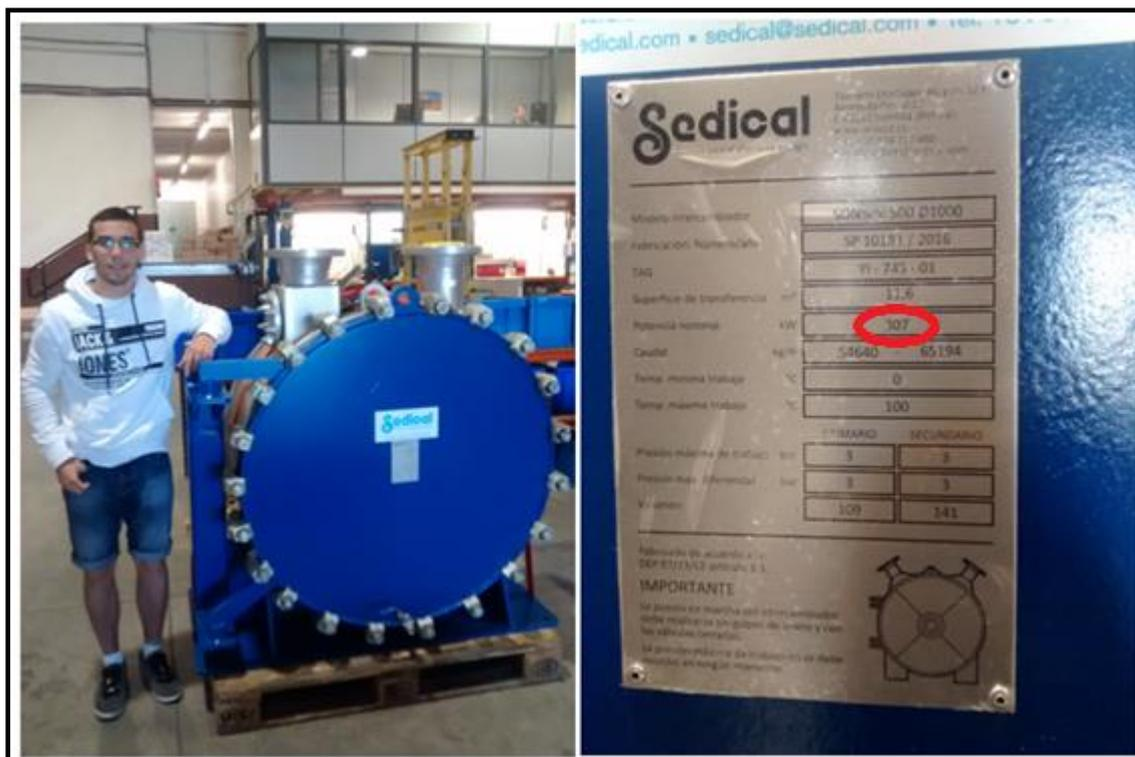
Figura 102. Intercambiador de calor en espiral para una planta de aguas residuales.
