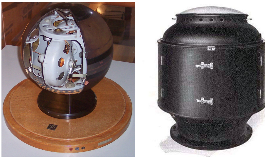
Figura 2.37: Fotografía del corte de la esfera de un girocompás Anschütz y girocompás original completo.
