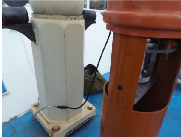
Figura 5.22: Fotografía de la conexión del cable del “fluxgate” a la instalación del buque y al CMI.
