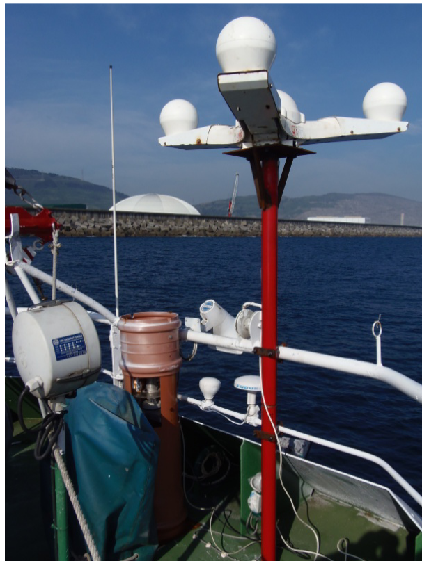
Figura 5.43: Fotografía del nuevo pedestal y nueva ubicación de la antena satelital.
