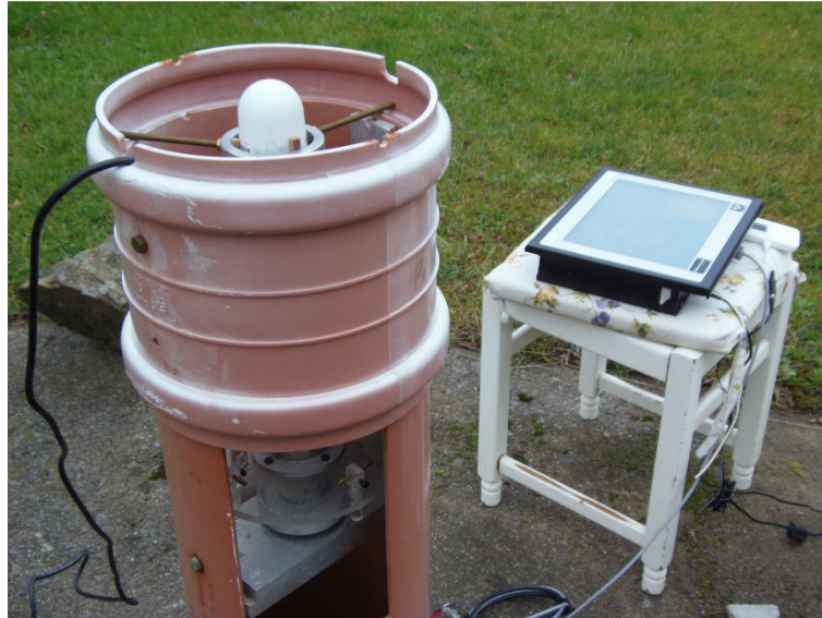
Figura 5.55: Equipo conectado y funcionando. En la parte superior de la pseudo-bitácora se ve al flux digital y en la inferior el plato con los imanes compensadores.
