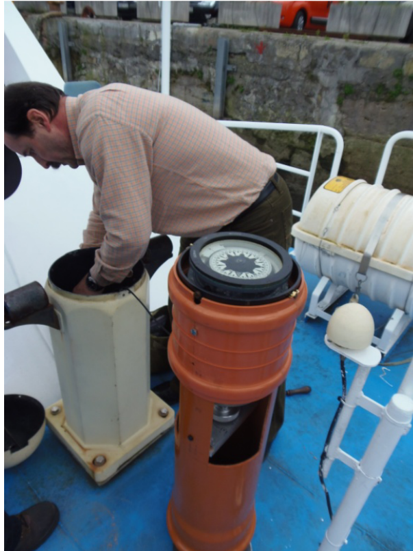
Figura 5.21: Fotografía de la instalación realizada para la nueva ubicación del pseudo-compás en la misma.
