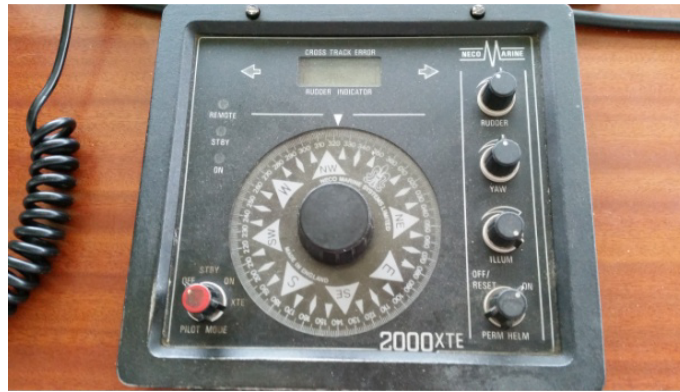
Figura 5.35: Fotografía del piloto automático conectado al fluxgate original de la aguja magnética.
