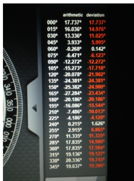
Figura 5.26: Fotografía del detalle de la captura de la pantalla del CMI con los desvíos captados por el mismo.
