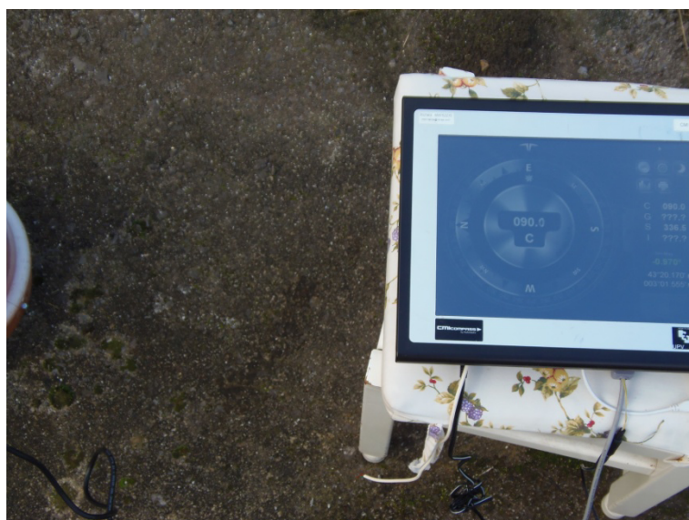
Figura 5.54: Equipo completo montado y en funcionamiento. CMI indicando Rumbo Este o 090.0°.
