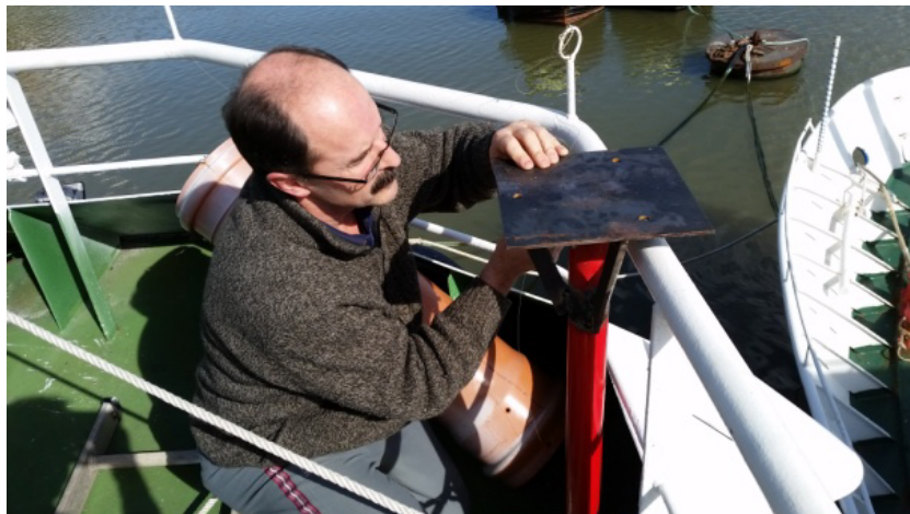
Figura 5.38: Fotografía de la colocación de la base de la antena satelital.
