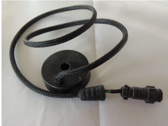
Figura 5.9: Fotografía de la pastilla fluxgate.
