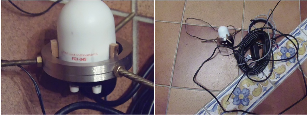
Figura 5.14: Fotografía del flux con la pieza de centrado y soporte. En la otra fotografía instrumento con cableado a utilizar.
