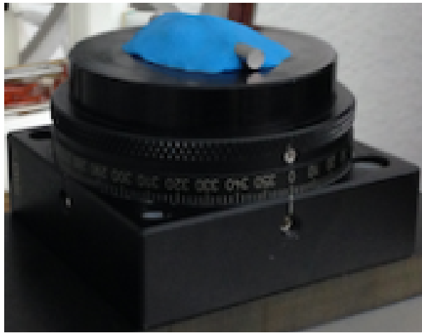
Figura 5.59: Fotografía representando la fijación de un imán corrector, que el autor utilizará en la experiencia, en el goniómetro de medición.
