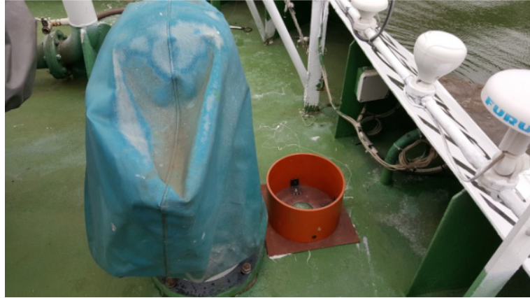
Figura 5.41: Fotografía de la nueva base de la bitácora colocada en su ubicación. Detrás la bitácora del Villa de Portugaleta con una protección de canvás o lona.
