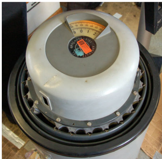
Figura 2.38: Fotografía de un girocompás Anschütz actual.
