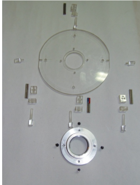
Figura 5.1: Despiece del plato de compensación y su distanciador. Fotografía del autor.
