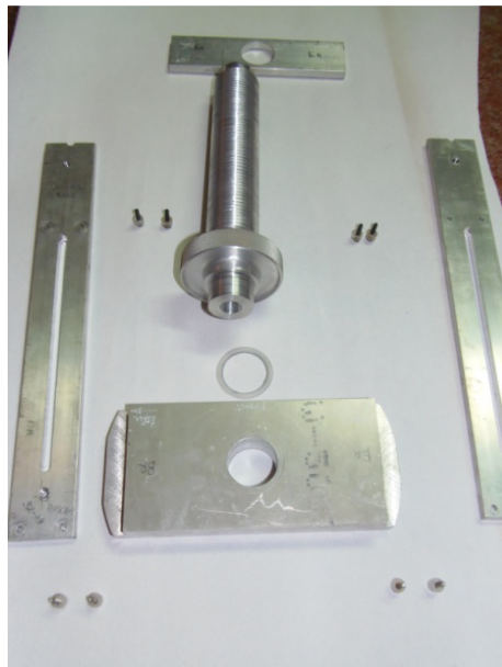
Figura 5.2: Despiece del soporte del plato de compensación. Fotografía y soporte del autor.
