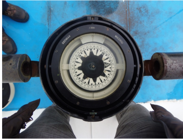
Figura 5.19: Fotografía de la bitácora y aguja originales del buque “Ortze”.
