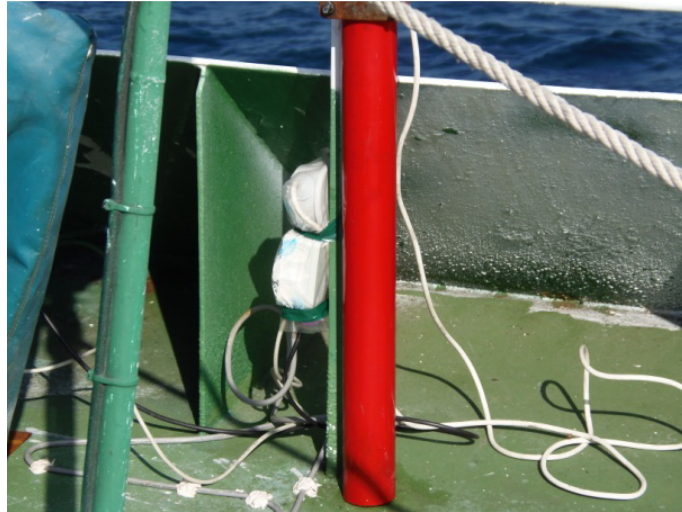
Figura 5.33: Fotografía con el cableado de conexión de la antena satelital y el fluxgate para la experiencia.
