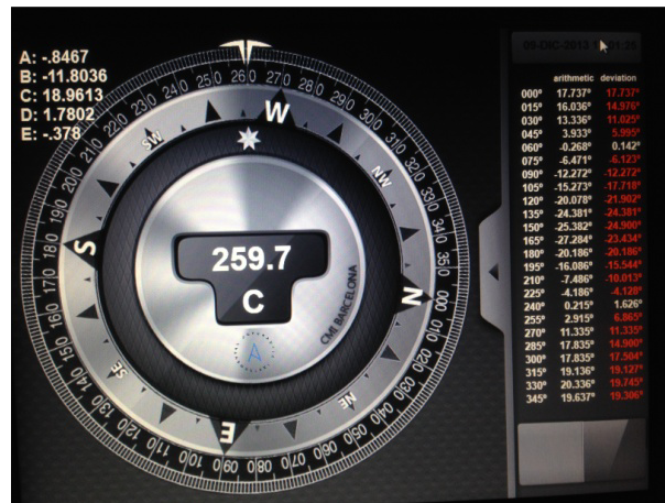
Figura 5.25: Fotografía de la captura de la pantalla del CMI con los desvíos registrados por el mismo.
