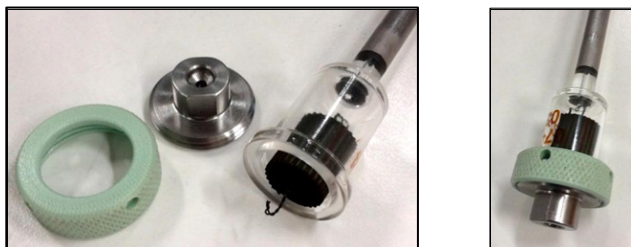
Figura 2.10. Portamuestras del porosímetro de mercurio con un monolito adaptado para su medida. Izquierda: monolito y piezas del portamuestras. Derecha: portamuestras montado.
