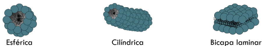
Figura 3.3. Algunas de las posibles estructuras de ordenación de las micelas de surfactante en un medio de disolución.
