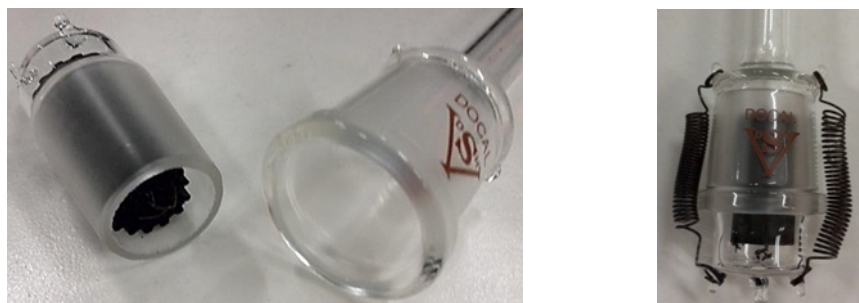
Figura 2.9. Imágenes de la celda de fisiorción de \text{N}_2 para monolitos. Izquierda: monolito introducido en el portamuestras. Derecha: celda montada.
