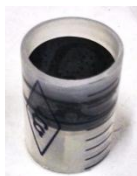
Figura 2.17. Cilindro graduado utilizado para preparar pastillas de catalizador a partir de sus suspensiones.
