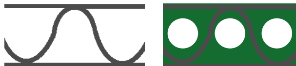
Figura 2.8. Representación del aspecto de los canales de los monolitos sin recubrimiento (izquierda) y con una elevada masa depositada (derecha).
