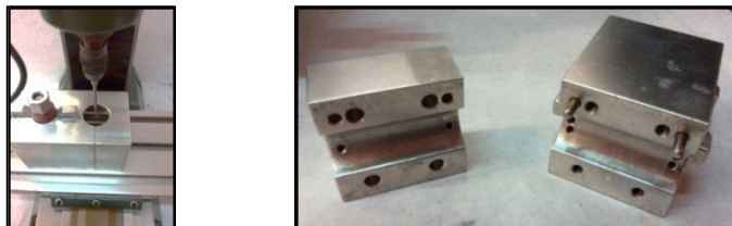
Figura 2.5. Detalle del sistema utilizado para realizar los agujeros de los termopares en el interior de los monolitos (izquierda). Sistema de sujeción del monolito en la fresadora (derecha).
