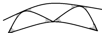
Figura 5.14. Acumulaciones de catalizador en los ángulos más agudos de los canales sinusoidales.
