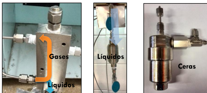
Figura 2.20. Imágenes del separador de líquidos (izquierda), trampa de líquidos (centro) y de ceras (derecha).
