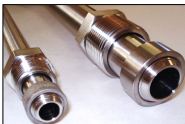
Figura 2.21. Imagen de los reactores tubulares de 9 mm y 17 mm con los correspondientes sistemas de cierre con tuerca y anillo.
