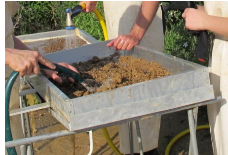
Figura 3.2 Proceso de lavado del sedimento con tamices de aluminio de 2 mm de luz de malla (a la derecha) y de 0.5 mm (a la izquierda).
