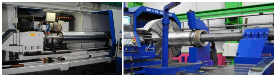
Figura 2.5 – Mecanizado de ejes de gran tamaño
