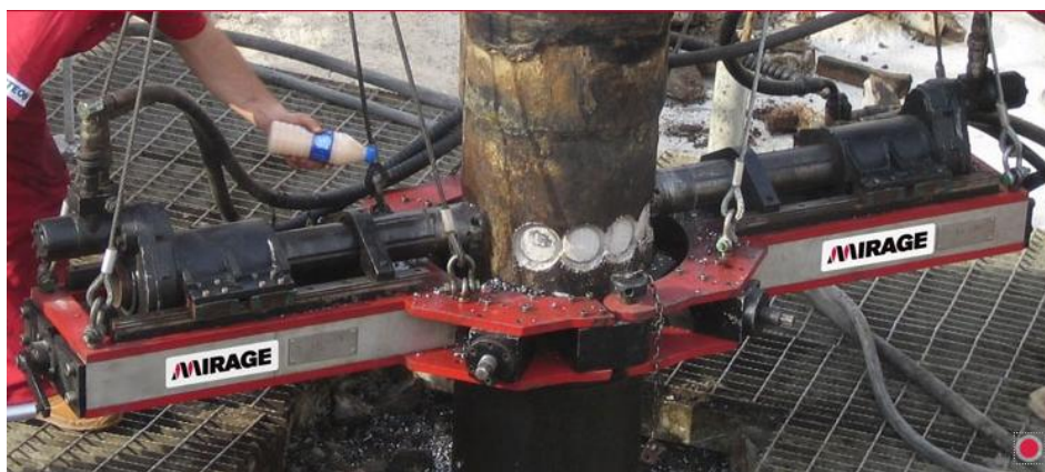
Figura 2.45 – Máquina anclada sobre la pieza de trabajo [Mirage, 2016]
