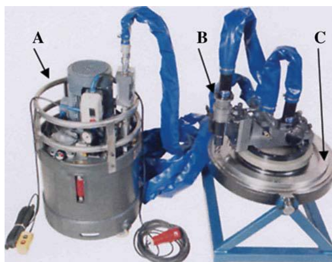
Figura 2.36 – Máquina de fresado orbital in situ para mecanizado y recuperación de cordones de soldadura [Rolls-Royce, 2007]. A-Generador de potencia hidráulica, B-cabezal de mecanizado, C-Pieza
