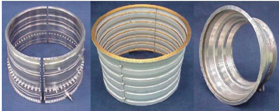
Figura 2.7 – Elementos de un motor turbojet de gran tamaño y pared delgada
