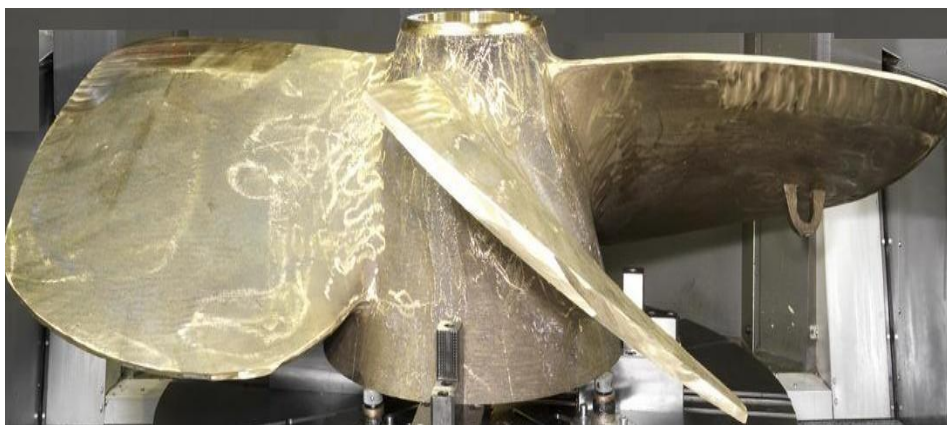
Figura 2.9 – Mecanizado de hélices propulsoras para barcos
