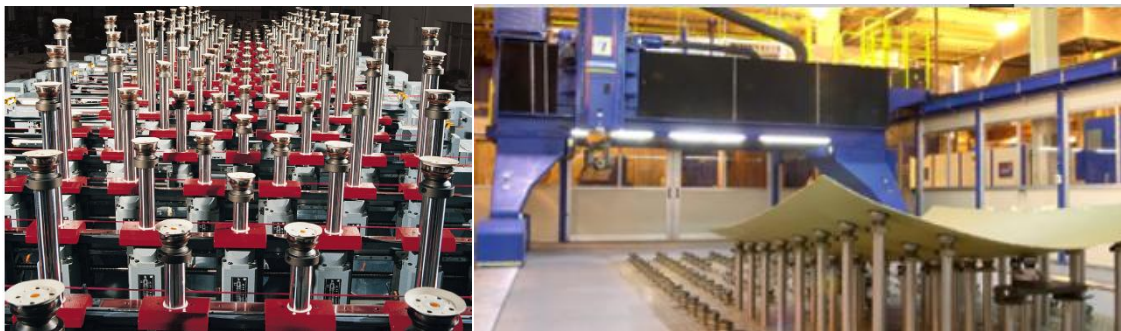
Figura 2.29 – Utillaje flexible universal de [MTorres, 2016]
