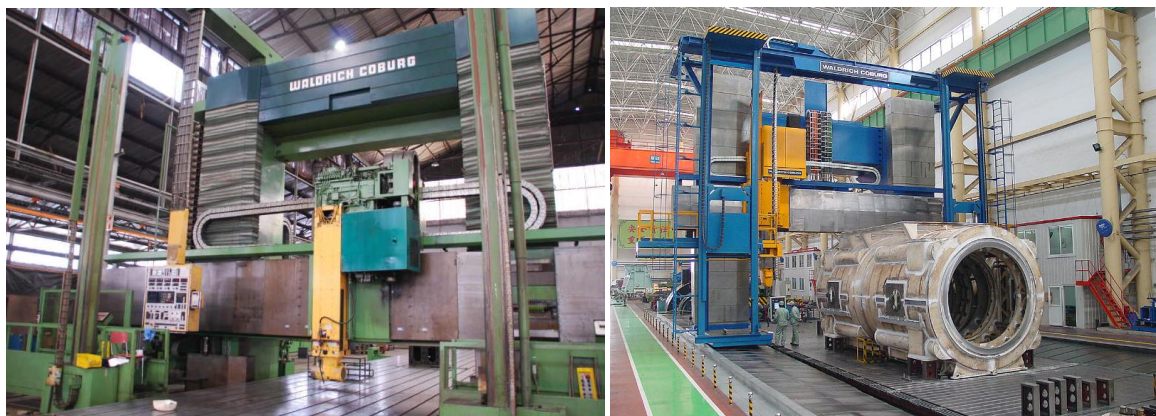
Figura 2.21 – Máquinas Waldrich-Coburg con accionamientos de piñón-cremallera
