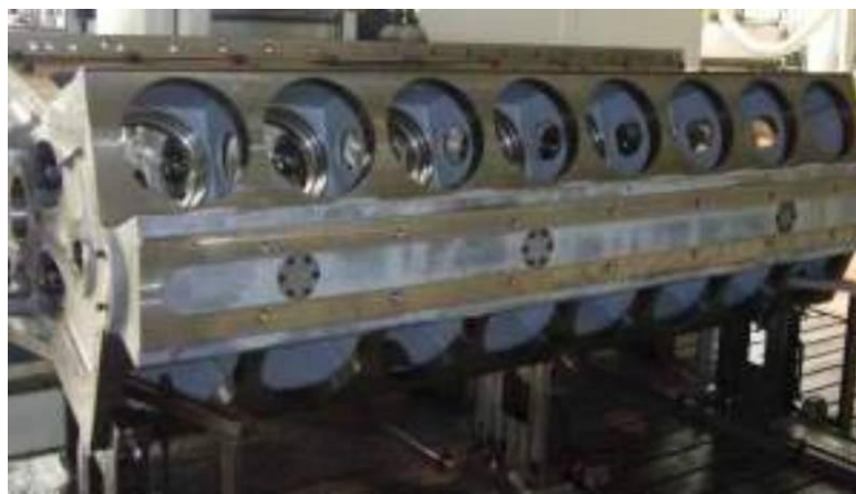
Figura 2.8 – Bloque motor un motor diésel para barcos
