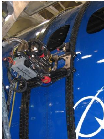
Figura 2.50 – Máquina portable con sistema flextrack [Electroimpact]
