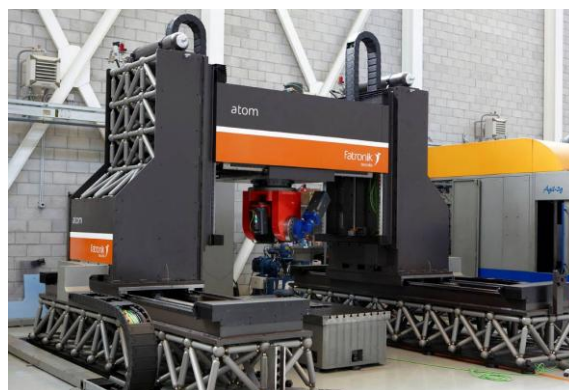
Figura 2.20 – Estructura de máquina modular mediante celosías [Zulaika, 2009]
