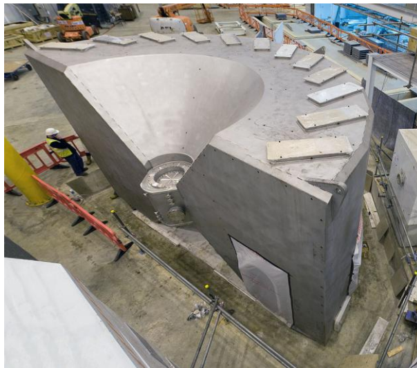
Figura 2.10 – Cámara de vacío del espectrómetro LET en ISIS/RAL
