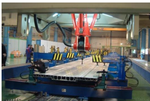
Figura 2.15 – Mecanizado de paneles para vagones con tecnología Tricept
