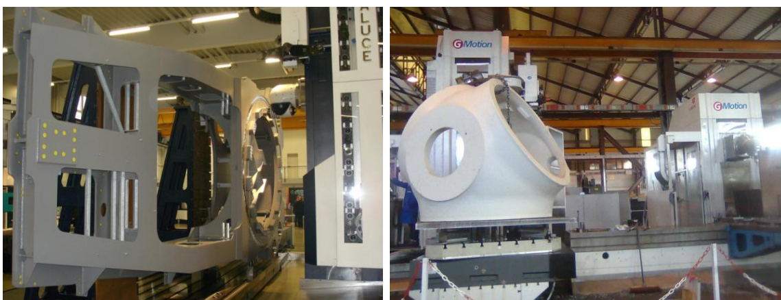
Figura 2.6 – Mecanizado del cuerpo central de un aerogenerador (izqda.). Mecanizado de bujes de aerogenerador (drcha.)
