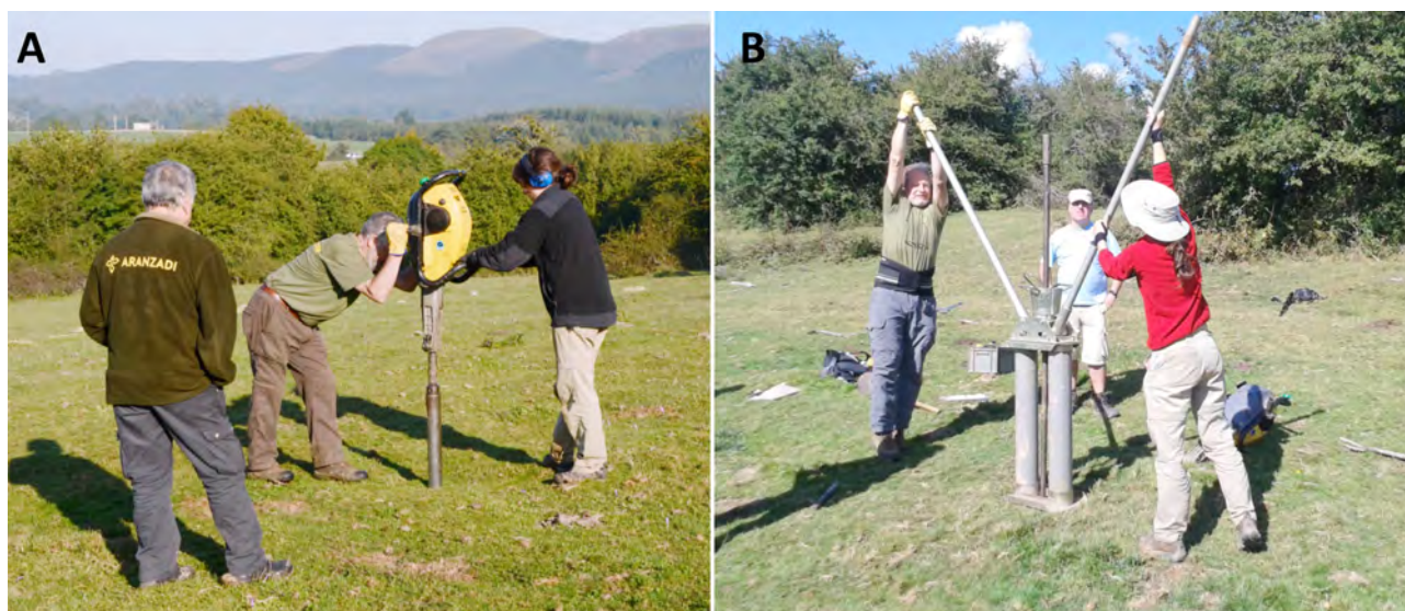
5.1. irudia: Zundak burutzeko erabilitako Cobra TT sistema.
