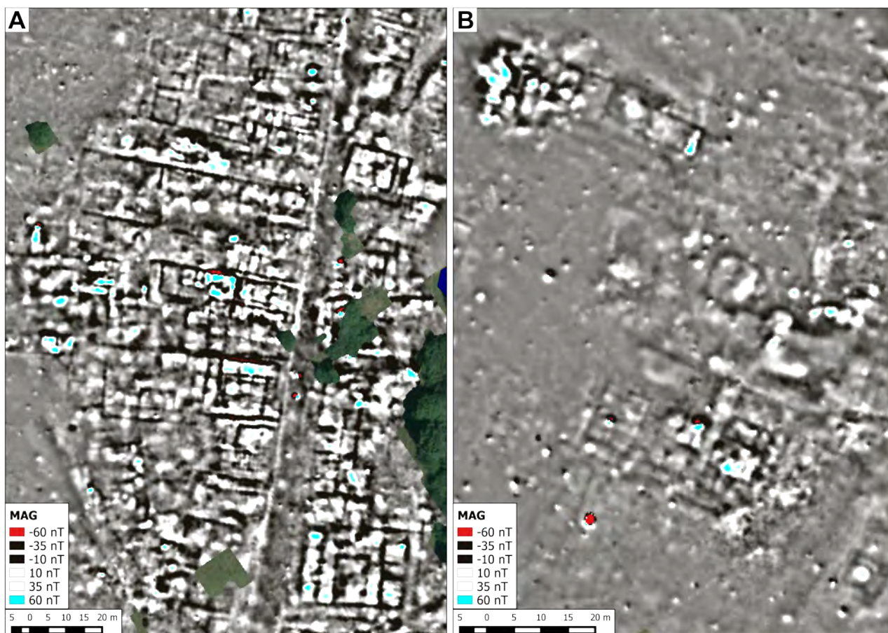
4.47. irudia: Kontraste altuko barnealdeak Auritz-Aurizberri aztarnategian. A. Okupazio-gune nagusia. B. P5 gunea. Bi kasuetan kolore eskala bera erabili da, 35nT baino intentsuagoak diren anomaliak nabarmenduz.
