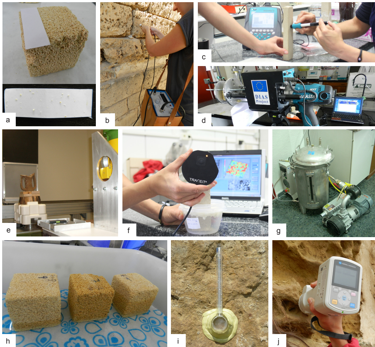
Figura 14. Algunas de las técnicas instrumentales analíticas y métodos de ensayo de caracterización empleados. a) Test de adhesión superficial en una muestra de calcarenita de Bizerta (Túnez); b) Velocidad de propagación de ultrasonidos medida in situ en el Fuerte Español de Bizerta; c) Micro-durómetro midiendo la dureza superficial de una muestra de piedra Bateig; d) Micro-drilling realizando el análisis en una de las muestras de piedra de Lecce; e) Fragmento de ánfora cerámica Tarraconense siendo analizado mediante tomografía de rayos-X para objetos de grandes dimensiones; f) Rugosímetro óptico midiendo la rugosidad superficial de una muestra de piedra Bateig; g) Equipo de absorción de agua a vacío utilizado; h) Ensayo de determinación de la absorción de agua por capilaridad en muestras de calcarenita de Bizerta; i) Ensayo de pipeta de Karsten in situ en el Fuerte Español de Bizerta; j) Espectrofotómetro midiendo in situ coordenadas cromáticas de las calcarenitas del Fuerte Español.
