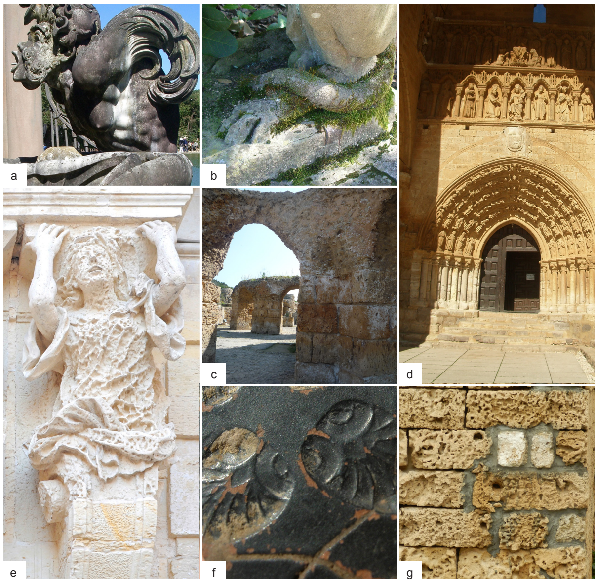
Figura 1. a) Escultura con costra negra en los jardines de Boboli (Florenia); b) Biodeterioro en escultura en los jardines de Boboli (Florenia); c) Eflorescencias salinas en las ruinas de Cartago (Túnez); d) Insolación en la portada de la catedral de Tudela (Navarra); e) Escultura Barroca de piedra de Lecce deteriorada (Italia) [annavee]©123RF.com; f) Pérdida de material en cerámica ibérica hallada en el yacimiento arqueológico Font de la Canya (Barcelona); g) Restauraciones inadecuadas y deterioro alveolar en sillares de calcarenita del Fuerte Español de Bizerta (Túnez).
