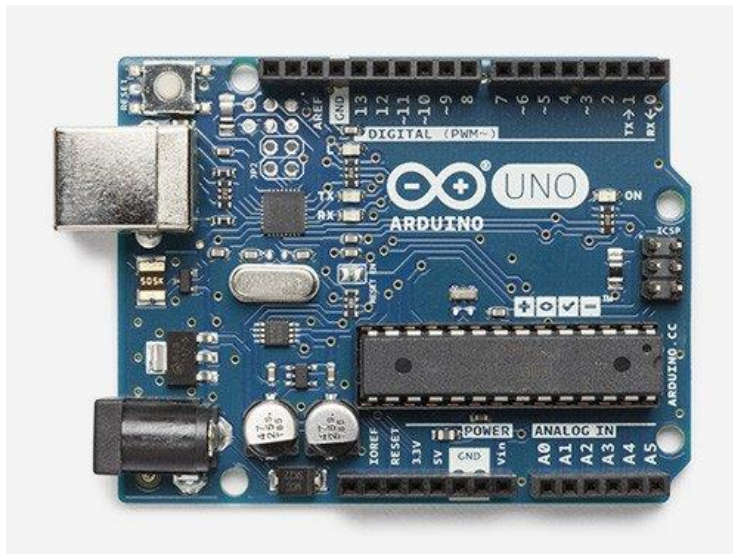
7.irudia. Arduino markako Arduino Uno txartela eta programatzeko erabiltzen den kablea.
