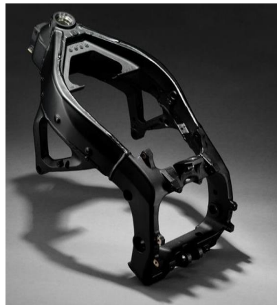
Figura 25. Chasis de doble viga perimetral. Yamaha R6
