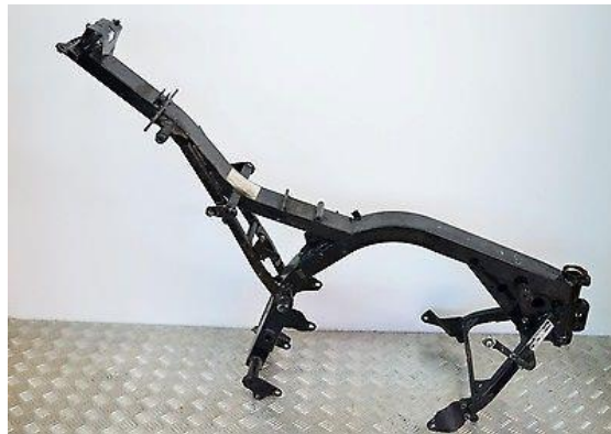
Figura 28. Chasis monoviga o espina central. Honda CB 600 F
