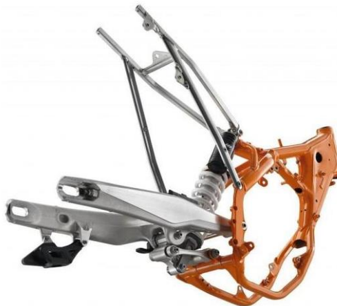
Figura 22. Chasis de simple cuna desdoblado. KTM 150 SX-F
