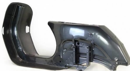
Figura 27. Chasis monocasco. Vespa
