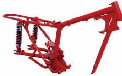
Figura 21. Chasis de simple cuna abierto o interrumpido. Ducati 24 horas
