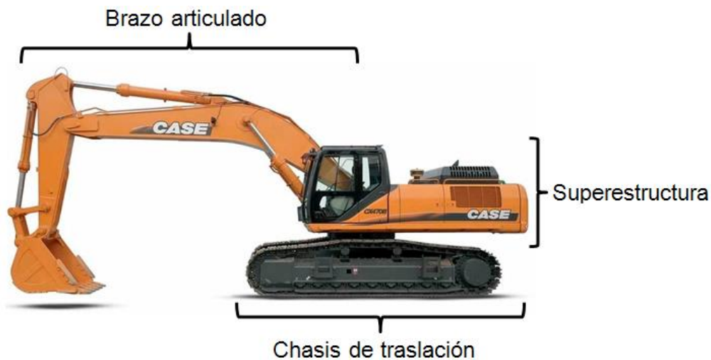
Figura 2. Grupos funcionales excavadora
