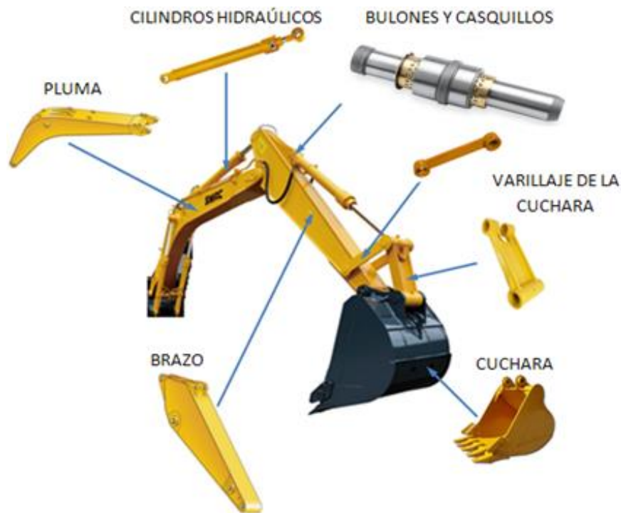
Figura 16. Elementos del brazo articulado
