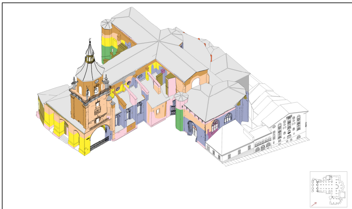
Figura 29. Plano de UUEE resultante de la lectura de los alzados de la Catedral Santa María
