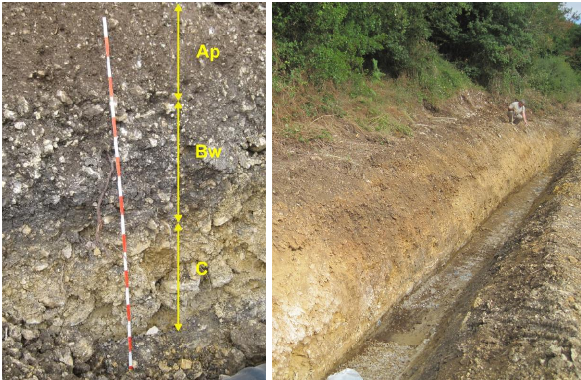
Figura 3.62. Distribución de horizontes en el pedión W171, localizado en el borde de la llanura aluvial-coluvial del Omecillo, unos 100 m aguas abajo de la confluencia con el barranco de Pozolao (UTM: X=483.032; Y=4.750.579). En la imagen dcha. se aprecia la morfología canaliforme de los horizontes coluviales.
