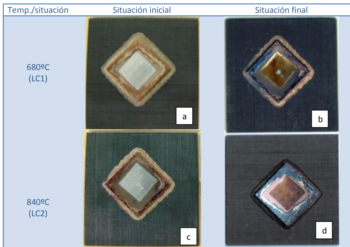
Figura 160: Probetas ensayadas a choque térmico antes y después del ensayo (50 ciclos).
