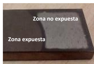
Figura 62: Efecto de la oxidación superficial en una pieza en las zonas expuestas tras un ciclo de braseado estándar.
