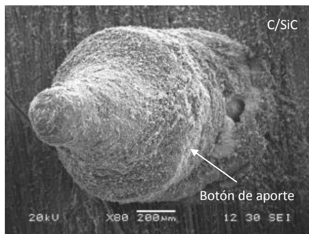
Figura 120: Superficie de fractura obtenida después de las pruebas del ensayo a cortadura de una probeta del tipo B1_D mostrando un “botón” metálico.
