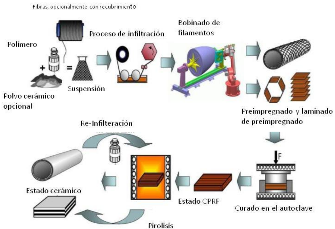
Figura 24: Esquema del procedimiento del proceso PIP definido por EADS.
