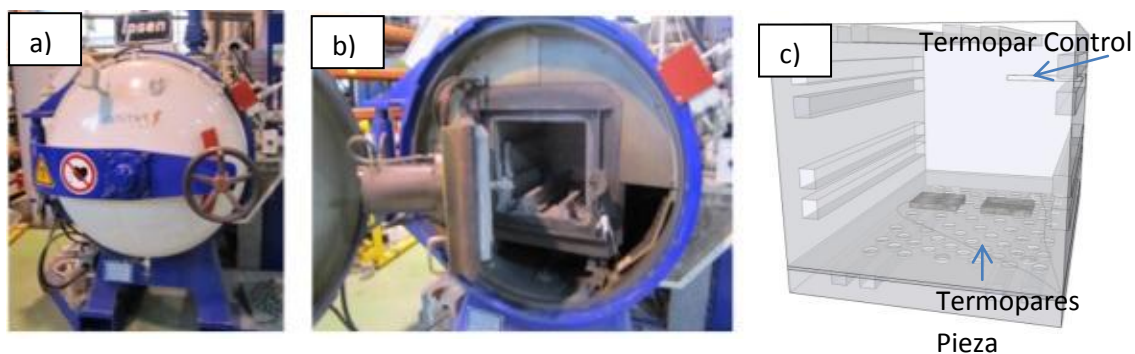
Figura 32: a) y b) Imágenes del horno de vacío usado para las uniones braseadas y c) esquema de la cámara del horno de braseado.
