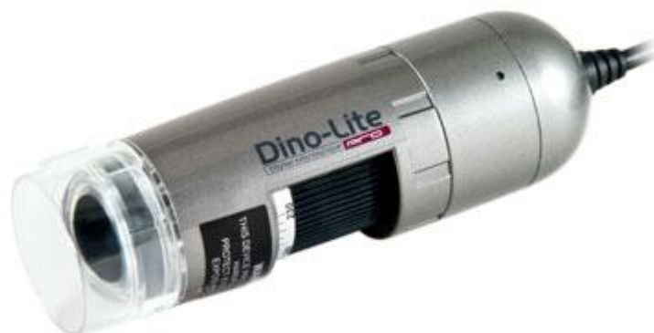
Figura 34: Imagen del microscopio digital utilizado para controlar la mezcla en el aporte.
