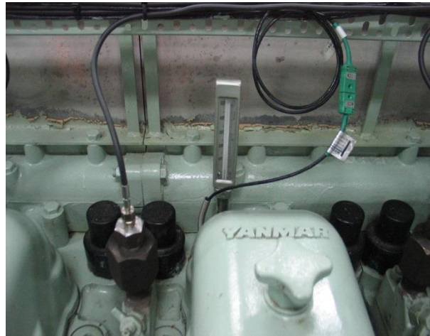
Figura C3- 13. Sensor de presión colocado en el cilindro n°2 (cable negro) y termopar tipo K colocado en la salida de escape del cilindro (cable verde)
