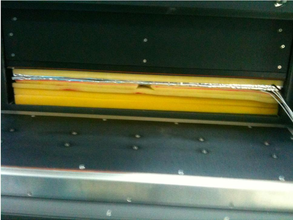
Figura 6.4: Muestra ensayada dentro del conductivímetro
