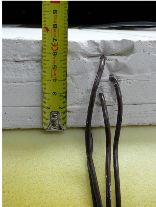
Figura 4.1: Vista del espesor de la probeta, donde se pueden observar las capas que la forman
