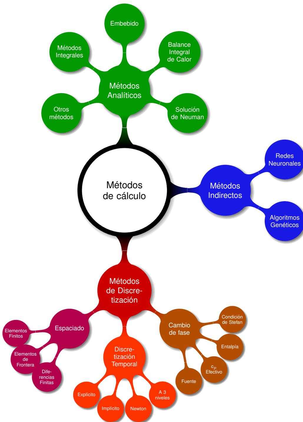
Figura 2.6: Métodos de cálculo para Materiales de Cambio de Fase
