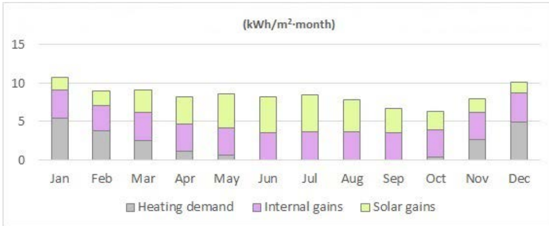
Fig. 6. CASO 01. Evolución mensual de las ganancias solares e internas y de la demanda de calefacción (Elaboración propia; 2017). CASE 01. Monthly distribution of solar and internal gains and heating demand (Own elaboration; 2017).
