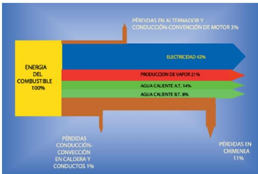
**Ilustración 9.** Desglose de un ejemplo de aprovechamiento energético en una instalación de cogeneración con motor alternativa de gas
