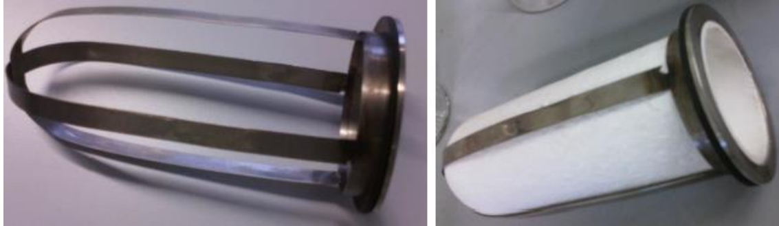
Figura 27. Soporte metálico del cartucho (izquierda) y soporte con el filtro colocado (derecha)
