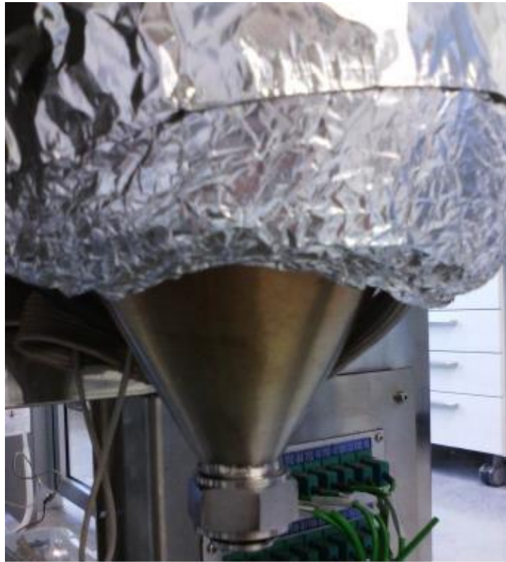
Figura 13. Tolva de recogida de charcoal vista desde abajo
