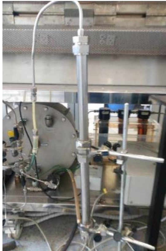
Figura 17. Torre doble de gel de sílice y carbón activado
