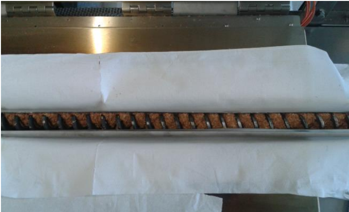
Figura 12. Tornillo impulsor dispuesto en el horno de pirólisis
