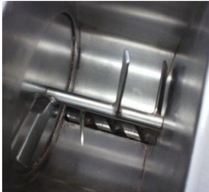
Figura 7. Aspas para remover la biomasa dentro de la tolva
