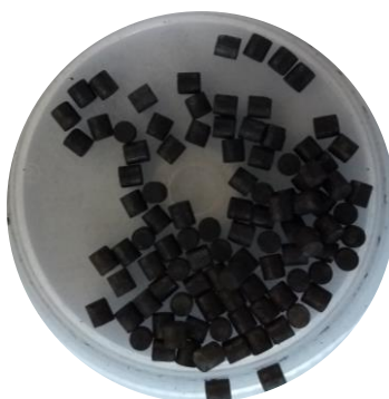
Figura 23. Catalizador CRG-LHR en su forma comercial
