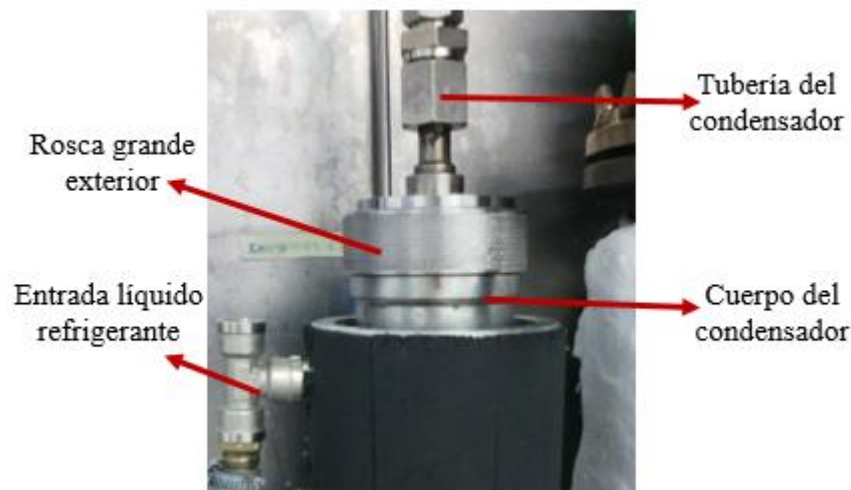
Figura 28. Condensador superior y sus partes principales
