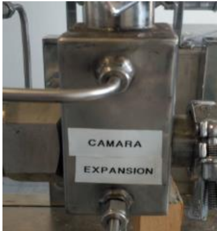
Figura 8. Cámara de expansión
