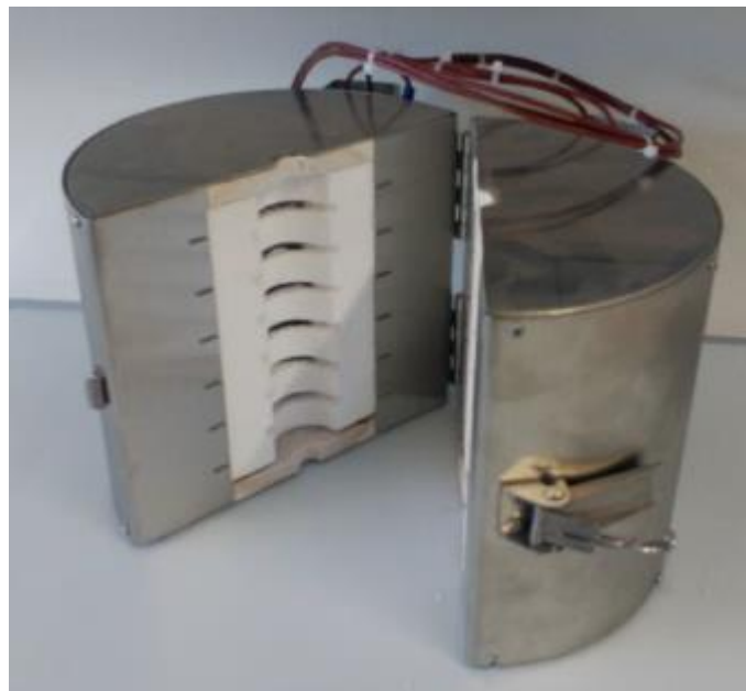
Figura 14. Reactor de tratamiento de vapores
