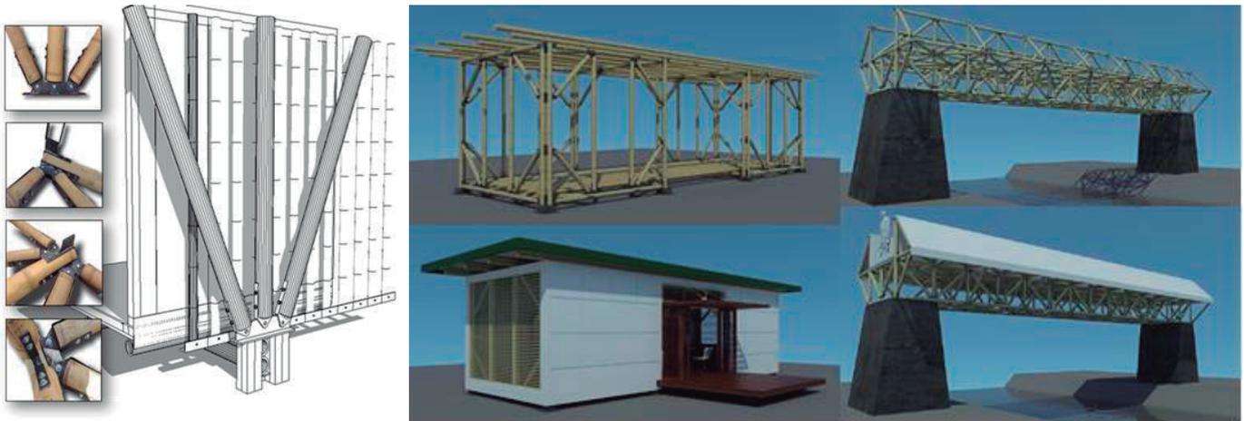
**Fig. 7.** (Izquierda) Sistema constructivo de uniones y envoltorio para muros estructurales con bambú. Joint system and bamboo structural walls.
