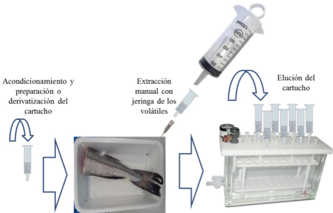
Figura 98: Montaje experimental para la extracción de volátiles del interior de las barquetas de pescado.
