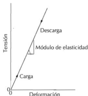
Figura 5.7.-Gráfica de esfuerzo-deformación que muestra una deformación elástica lineal (Callister, 2012)
