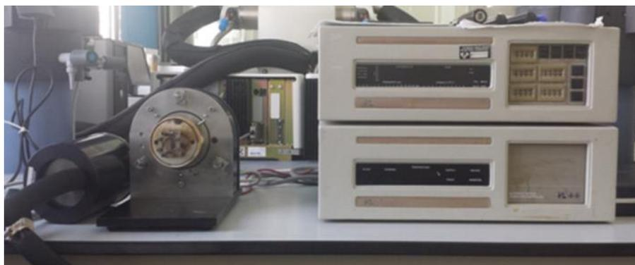
**Figura 2.2. Analizador DMTA Polymer Laboratories Mark II.**
