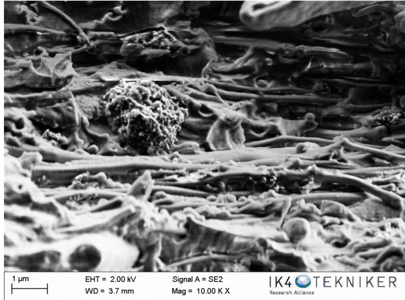
**Figura 5.58. Micrografía SEM del composite con tres velos de PA6 Ultramid + 25 % TiO<sub>2</sub>.**
