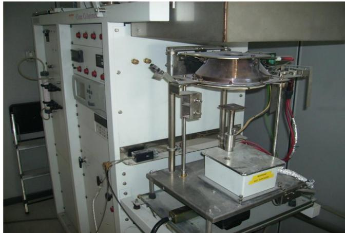
**Figura 2.17. Dispositivo del cono calorimétrico.**
