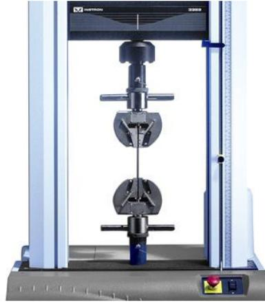
**Figura 2.12. Maquina universal de ensayos INSTRON 3369.**
