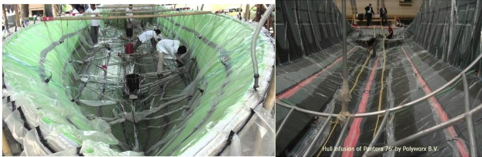
**Figura 2.20. Fabricación de embarcaciones mediante el proceso de infusión.**
