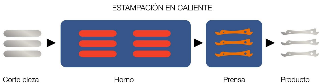
Figura 6.2: Esquema del proceso de estampación en caliente para piezas estructurales de vehículos.
