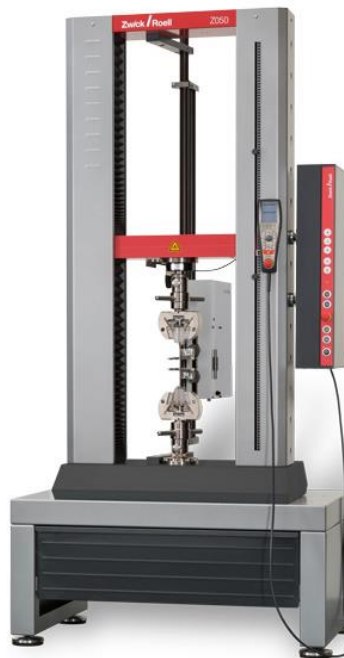
Figura 7.3: Máquina de tracción universal de Zwick Roell de 5 toneladas de fuerza de la MGEP.
