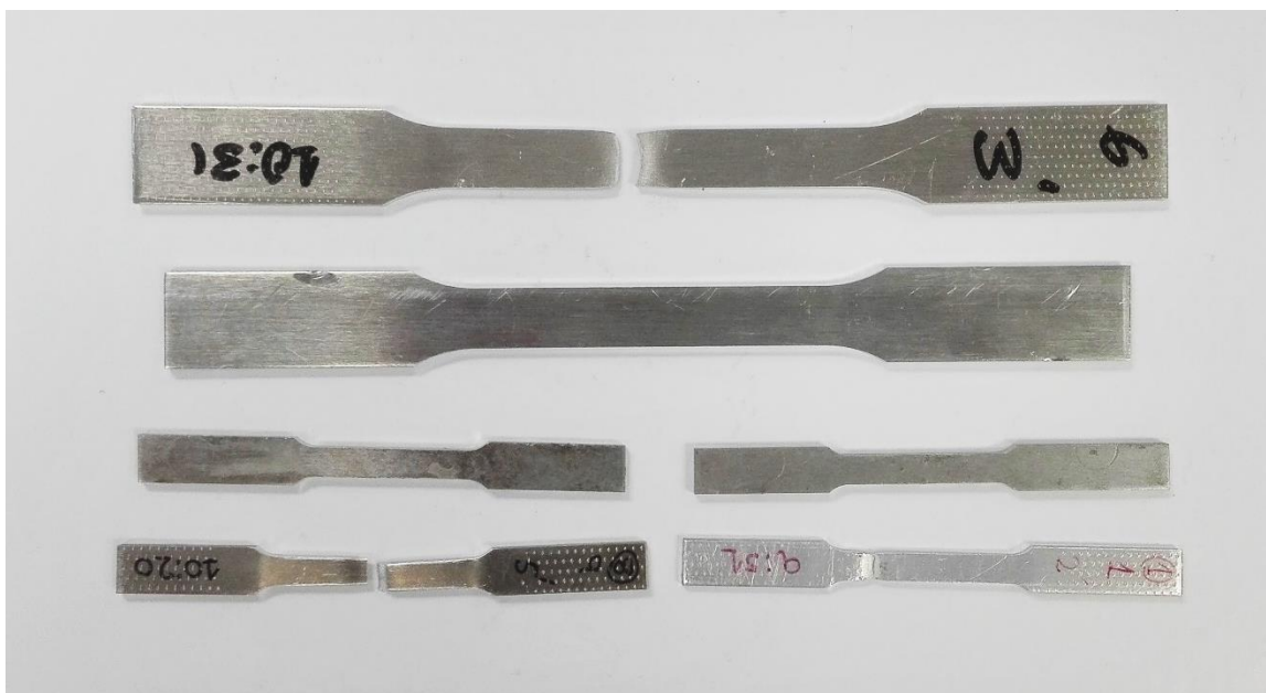
Figura 13.3: Probetas de 200 y 100 mm de largura de AA7075 y AA6082, fracturadas dúctilmente y sin fracturar.
