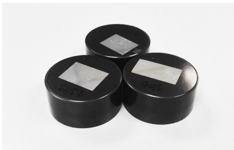
Figura 7.6: Muestras de AA7075 y AA6082 pulidas con un acabado espejo engastadas en resina negra termo-endurecida.
