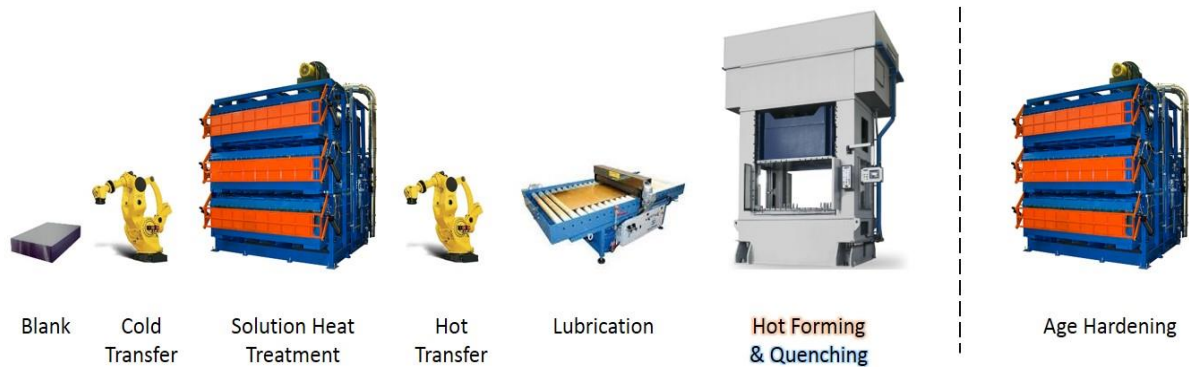
Figura 5.6: Esquema de los diferentes puestos de trabajo para el proceso de Hot Stamping/Forming
