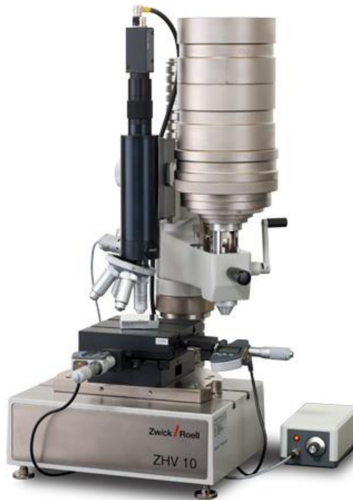
Figura 13.7: Durómetro ZHV10 Vickers de Zwick Roell en la MGEP.
