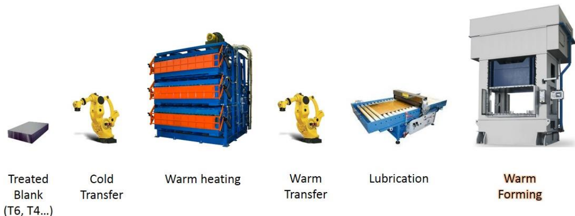
Figura 5.7: Esquema de los diferentes puestos de trabajo para el proceso de Warm Forming
