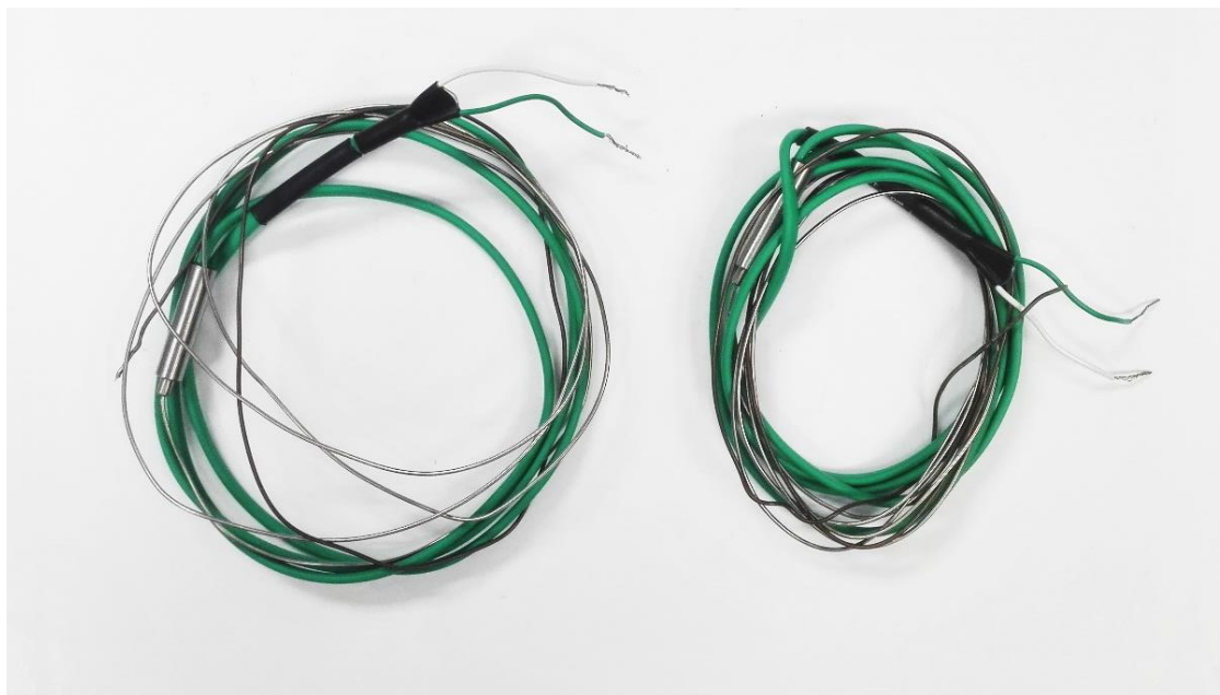
Figura 13.9: Termopares de 1 mm de diámetro de tipo "K" empleados para medir los perfiles de temperatura
