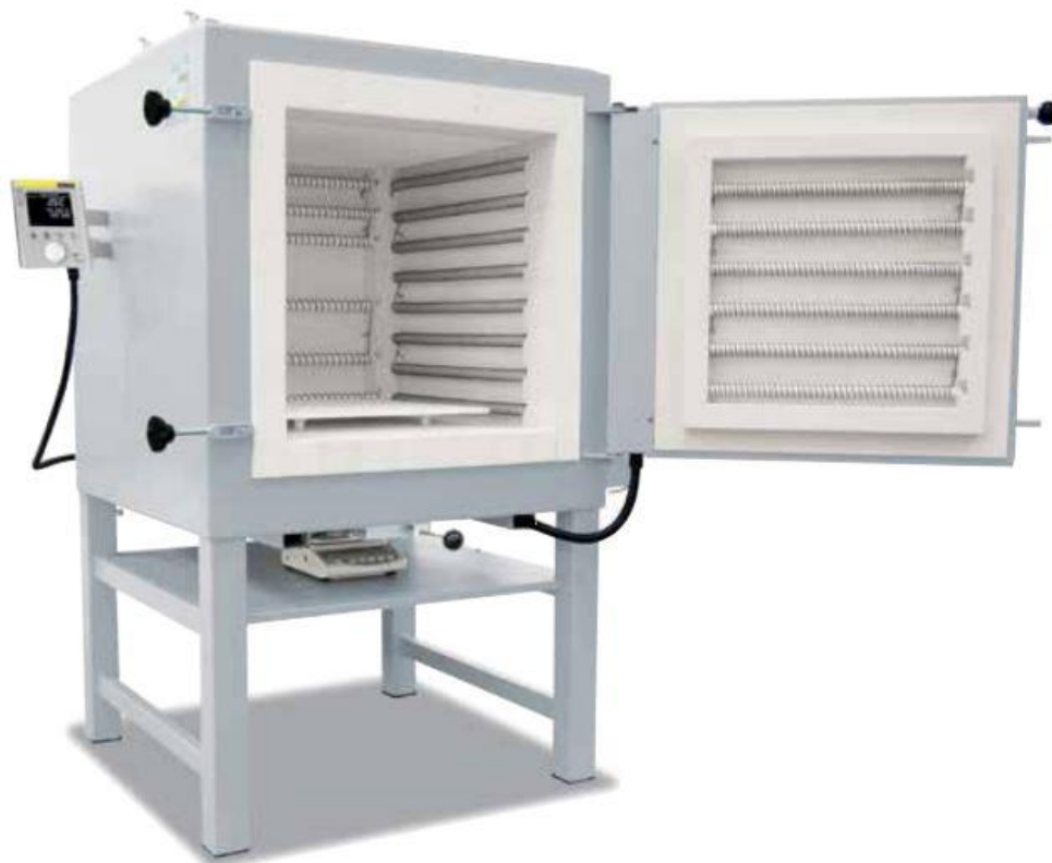
Figura 13.5: Horno eléctrico Nabertherm LH60/14 sin ventilador de la MGEP.
