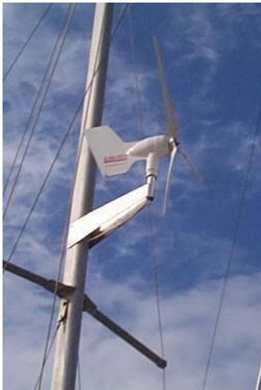
Figura 12 Mini-aerogenerador instalado en un mástil de embarcación.
