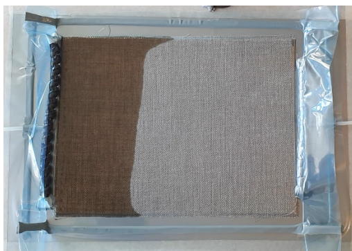
Figura 22 Proceso de impregnación de los refuerzos
