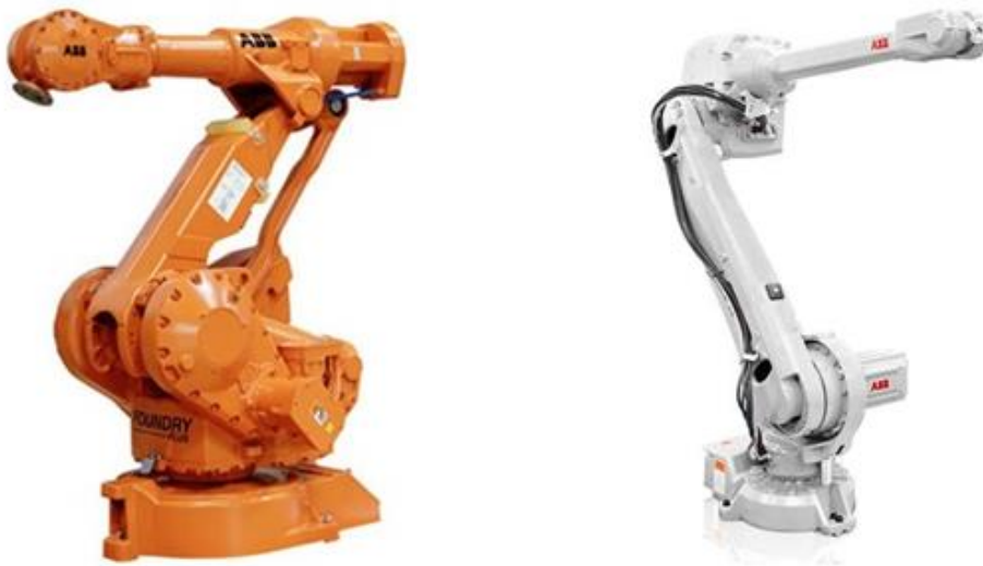
Ilustración 26: Robot ABB modelo IRB4400 (izquierda) y IRB4600 (derecha).
