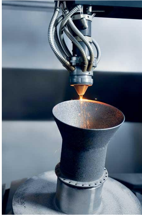
Ilustración 25: Fabricación aditiva con 5 ejes simultáneos. Fuente: Polygonica.
