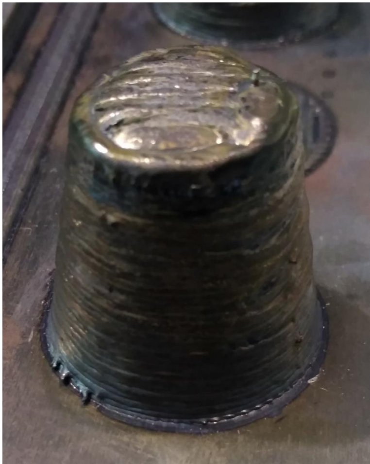
Imagen 2: Resultado de la fabricación de un semi-cono mediante trayectoria híbrida en 3 ejes y material en hilo.
