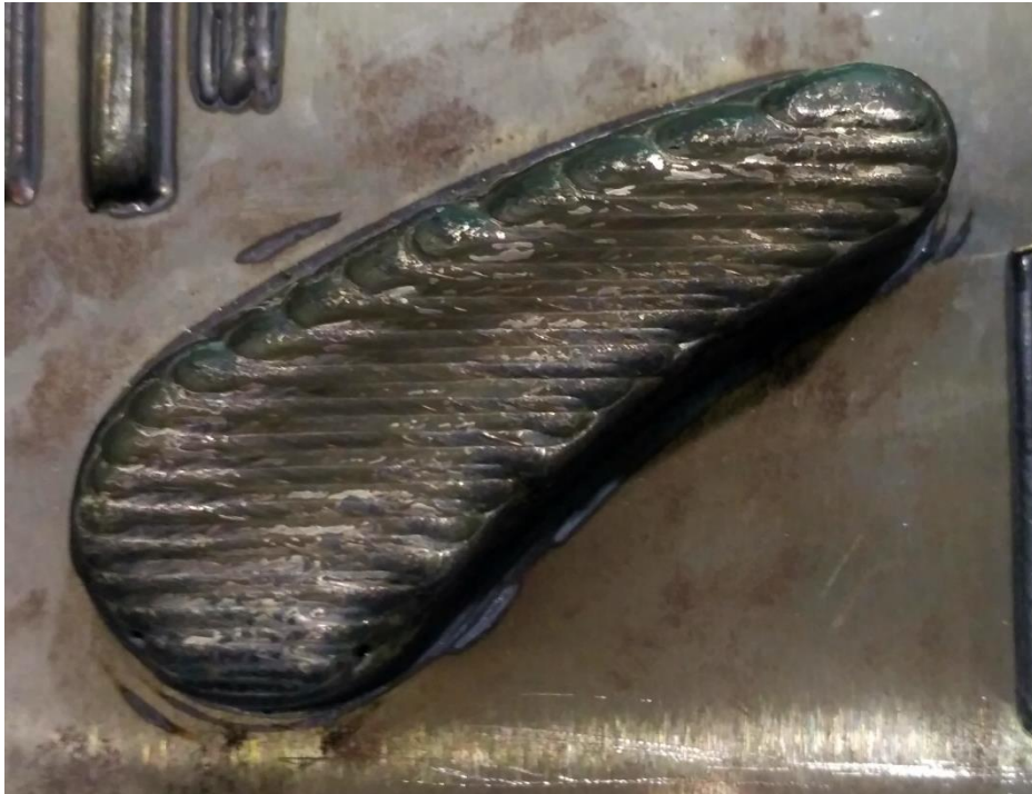
Imagen 5: Vista de planta del resultado de la fabricación de un alabe mediante trayectoria híbrida en 3 ejes y material en hilo.
