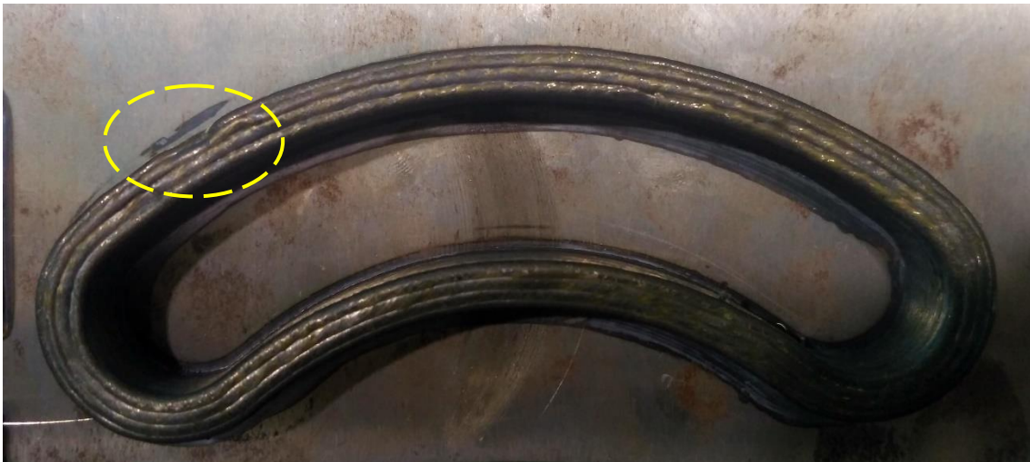
Imagen 10: Vista en planta de pared curva mediante trayectoria de varios perímetros, movimiento en 3 ejes y 4 contornos por cada capa.
