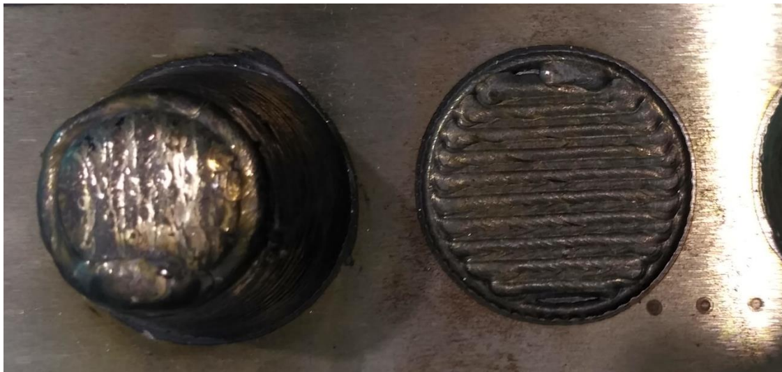
Imagen 3: Vista de planta del resultado del semi-cono fabricado (izquierda) y una de las capas del comienzo de la fabricación del semi-cono (derecha) con 3 ejes y material en hilo.
