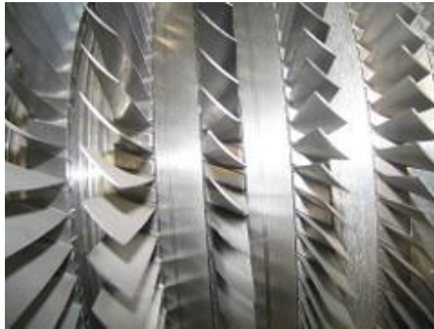
Ilustración 28: Alabes del rotor del compresor de una turbomáquina. Fuente: Piziadas.
