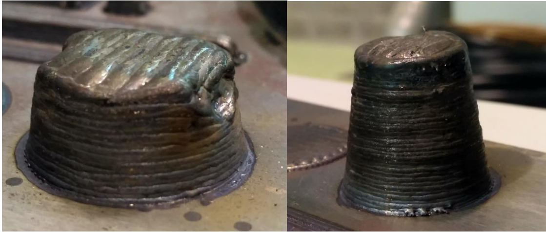
Imagen 12: Fabricación mediante movimiento en 3 ejes y hilo. A la izquierda sin adaptar los extremos del zigzag, y a la derecha adaptando dichos extremos.
