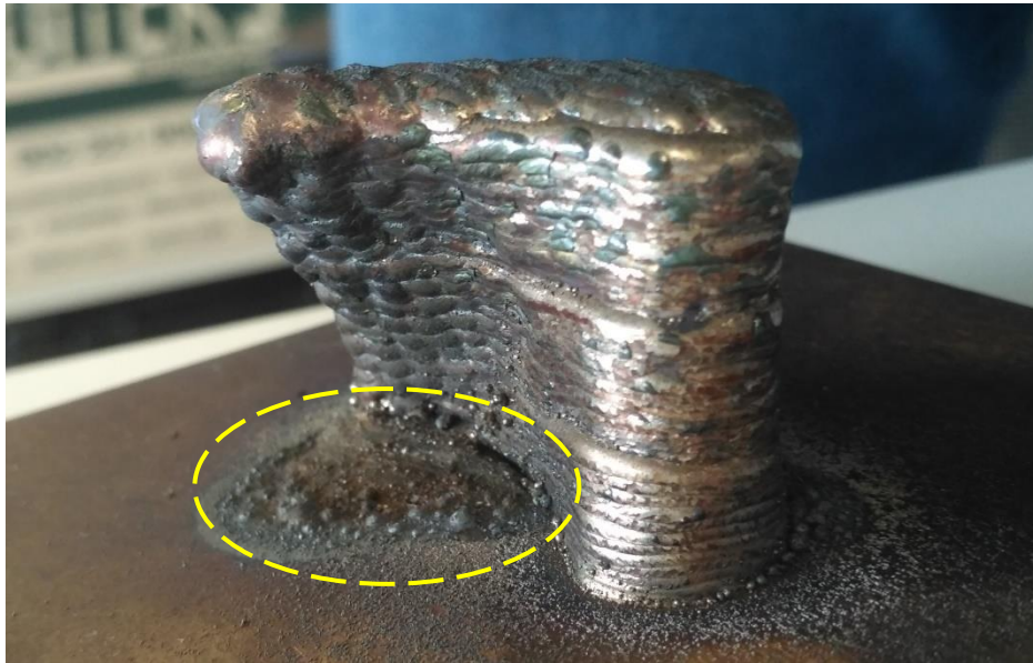
Imagen 7: Pared curva inclinada mediante trayectoria híbrida en 3 ejes y material en polvo.
