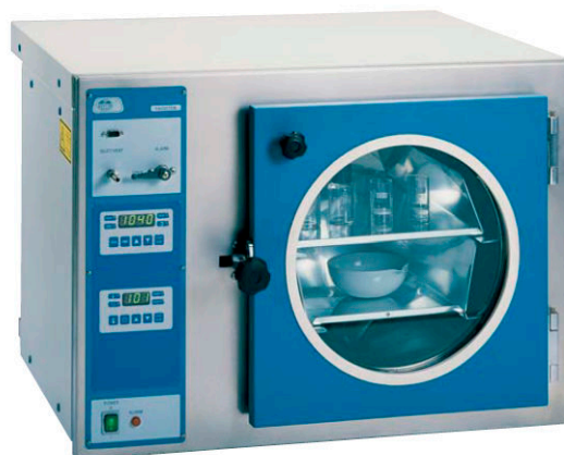
Irudia 22. Partikulak lehortzeko erabilitako labea.
