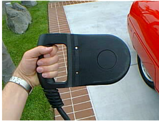
2.21. irudia. GM EV1-aren kargagailu inдукtiboak (IPT).
