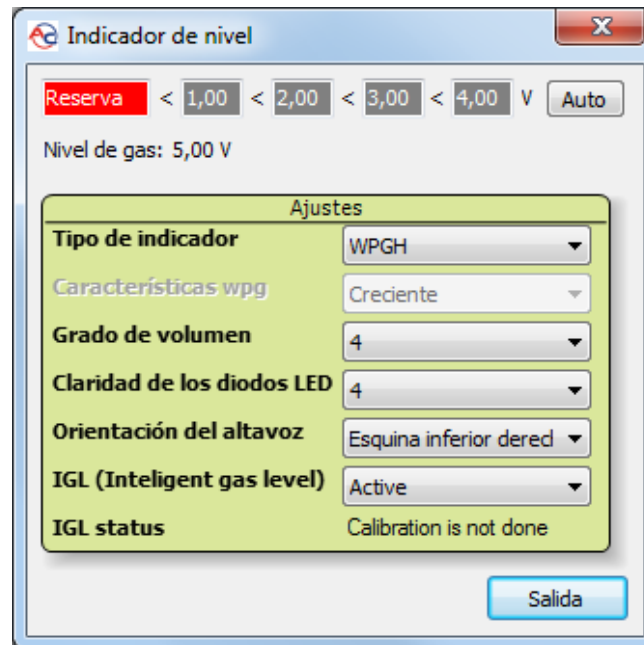
Figura 26 Ventana de configuración del indicador del nivel de gas
