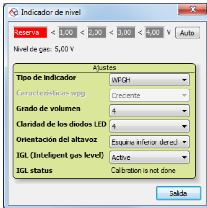
Figura 57 Ventana de configuración del indicador del nivel de gas
