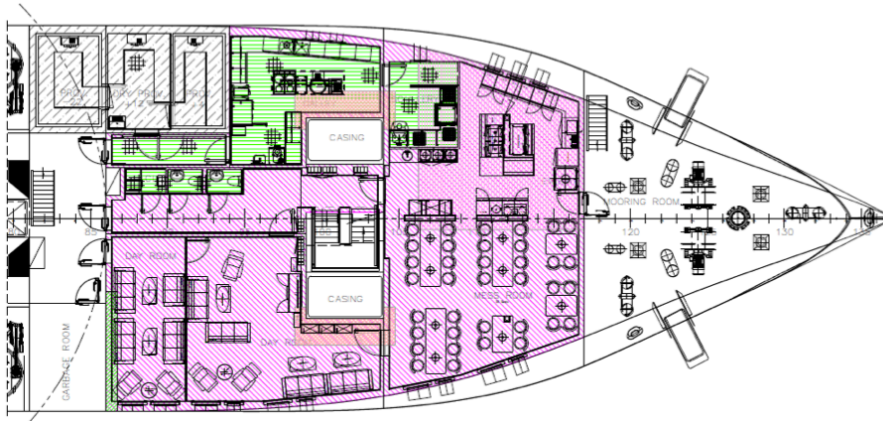
Imagen 70. Aislamiento de la cubierta A: suelos.
