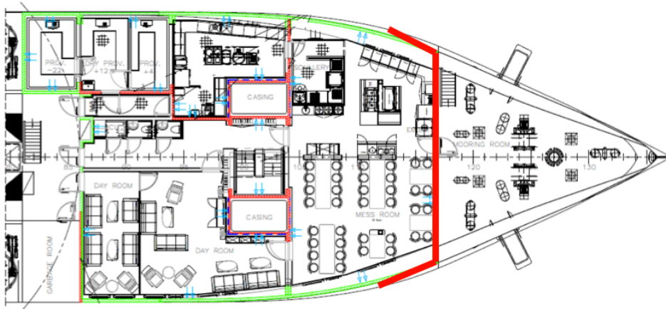
Imagen 69. Aislamiento de la cubierta A: mamparos.
