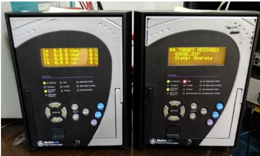
23. irudia. Erreleen abisuak bigarren saiakeraren ondoren.
