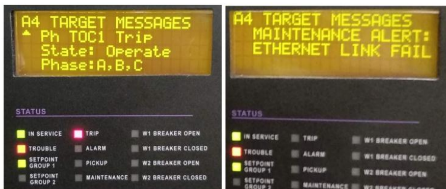
25. irudia. Multilin 345 erreleak eman dituen bi abisuak hirugarren saiakera burutzean.
