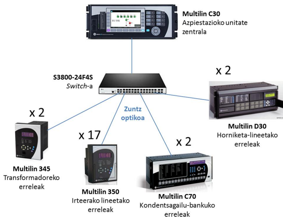
12. irudia. Azpiestazioko automatizazio-sistemaren konexio-eraketa. Irudien iturria: General Electric eta fs.com.
