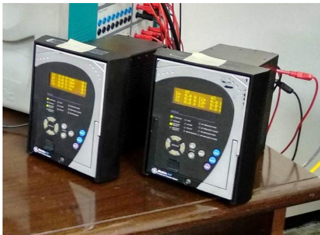
14. irudia. Multilin 350 eta Multilin 345 erreleak, Ingeniaritza Elektrikoko Saileko laborategian.
