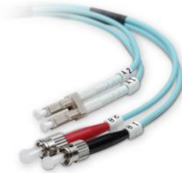
9. irudia. LC (goian) eta ST (behean) konektoreak. Iturria: Wikimedia Commons.
