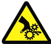
Imagen 7.1: Riesgo por atrapamiento
