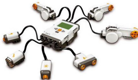
Figura 3: Microprocesador NXT conectado a tres servomotores y cuatro sensores.
