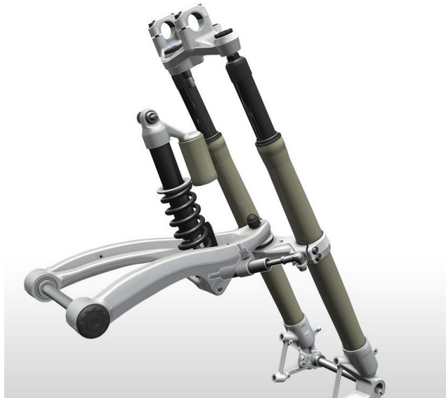
Figura 1.5 sistema de suspensión delantera telelever de BMW
