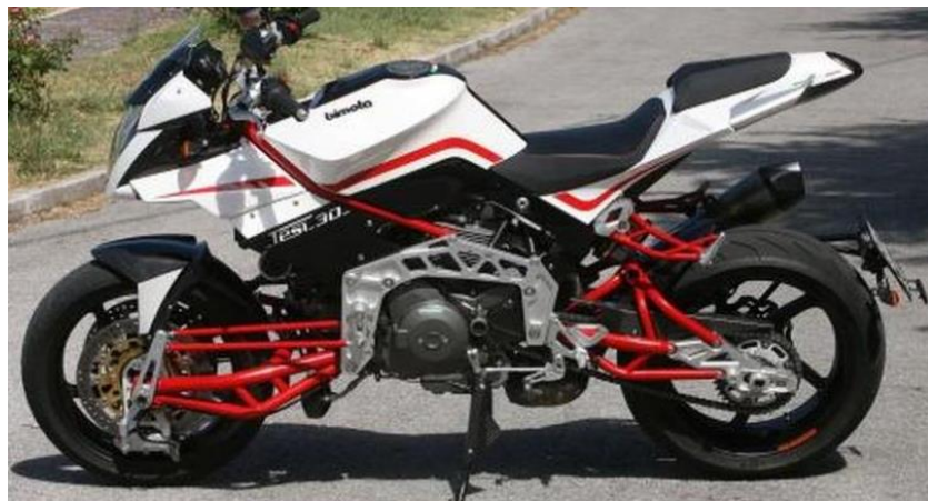
Figura 1.2 suspensión delantera con basculante delantero de Bimota Tesi
