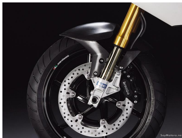
Figura 1.1 suspensión delantera con horquilla invertida de Ducati
