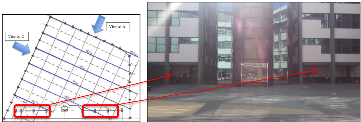
Figura 47. Las direcciones de viento aplicadas con los huecos de la plaza redondeados.
