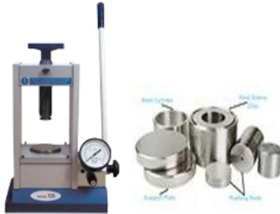
Ilustración 9. Prensa hidráulica y accesorios
