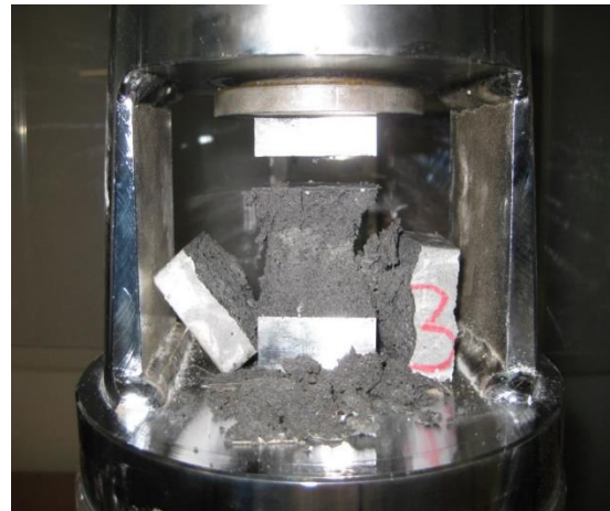
Ilustración 27. Ensayo de compresión después de rotura
