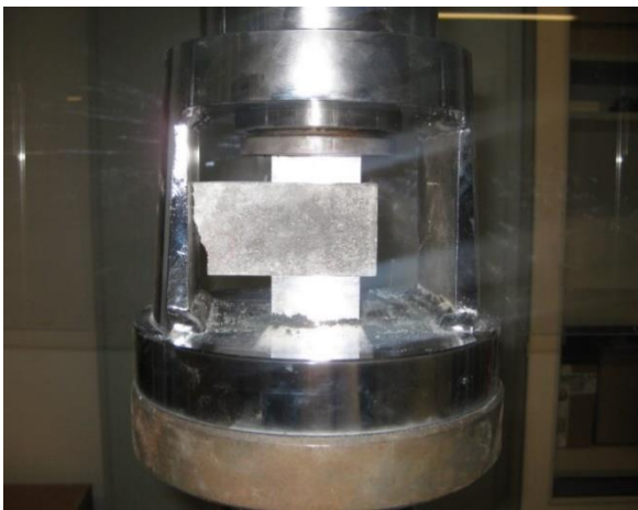
Ilustración 26. Ensayo de compresión antes de rotura
