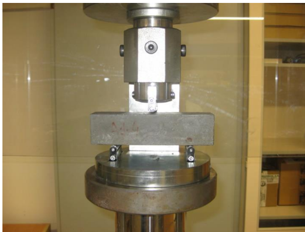
Ilustración 20. Ensayo de flexión antes de rotura
