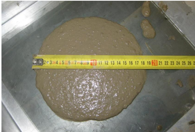
Ilustración 11. Medición de la consistencia
