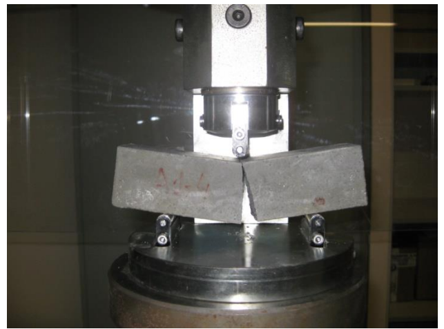
Ilustración 21. Ensayo de flexión después de rotura
